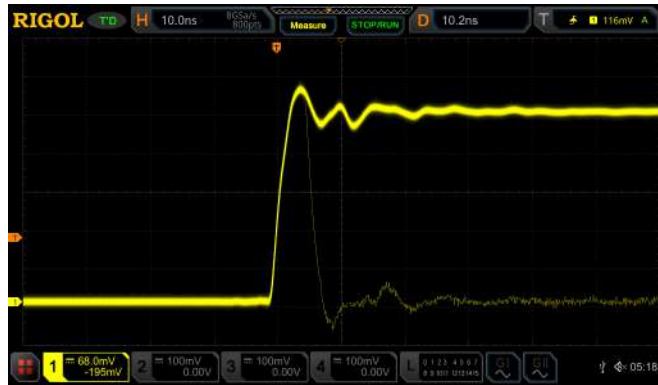
Figura 2.2: Capture señales excepcionales ocasionales en modo de alta frecuencia de refresco.
