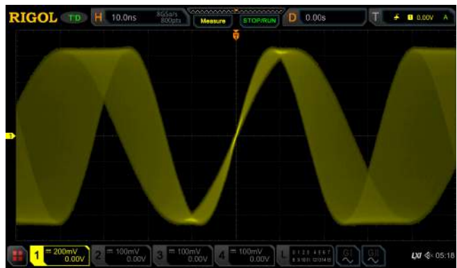
Figura 2.3: Los cambios de cada cuadro de formas de onda de la señal de barrido se pueden observar claramente en el modo de alta actualización.
