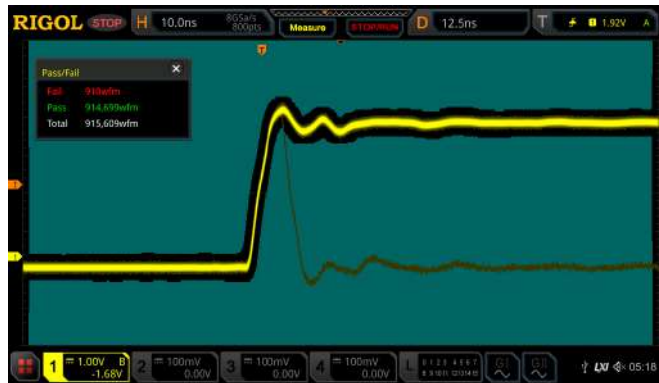
Figura 2.6: La función de prueba paso/fallo puede realizar rápidamente estadísticas sobre la probabilidad de ocurrencia de las excepciones de señal.
