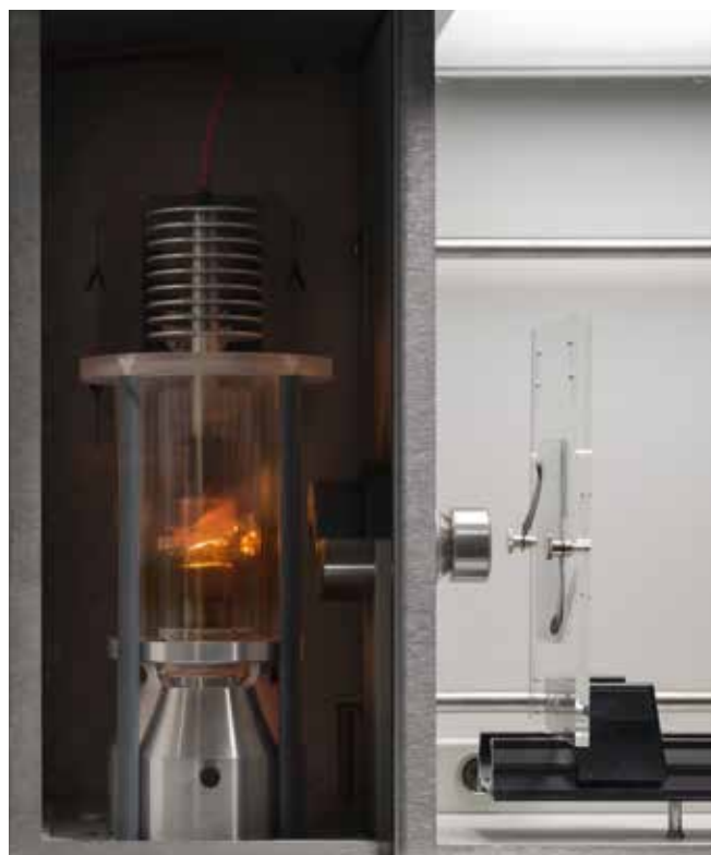
Creación de un diagrama de Laue en una película de rayos X.
