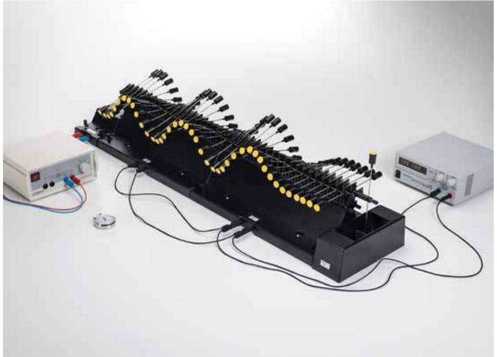
Longitud de onda, frecuencia y velocidad de fase en ondas viajeras (P1.6.2.1)
