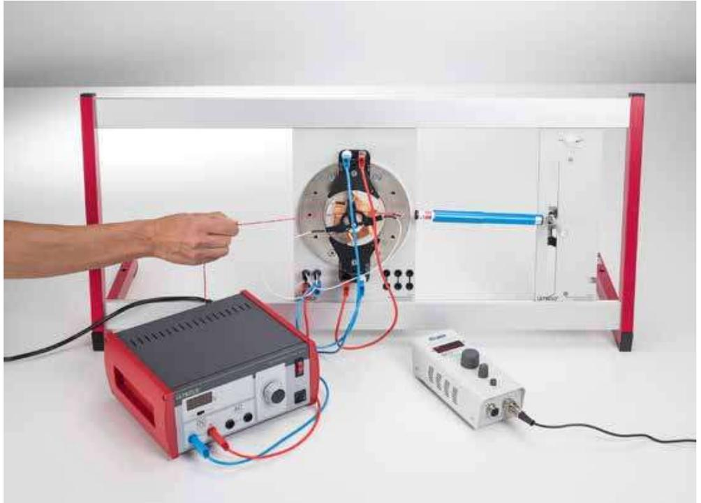
Estudio de un motor universal en conexión en derivación (P3.5.3.3)
