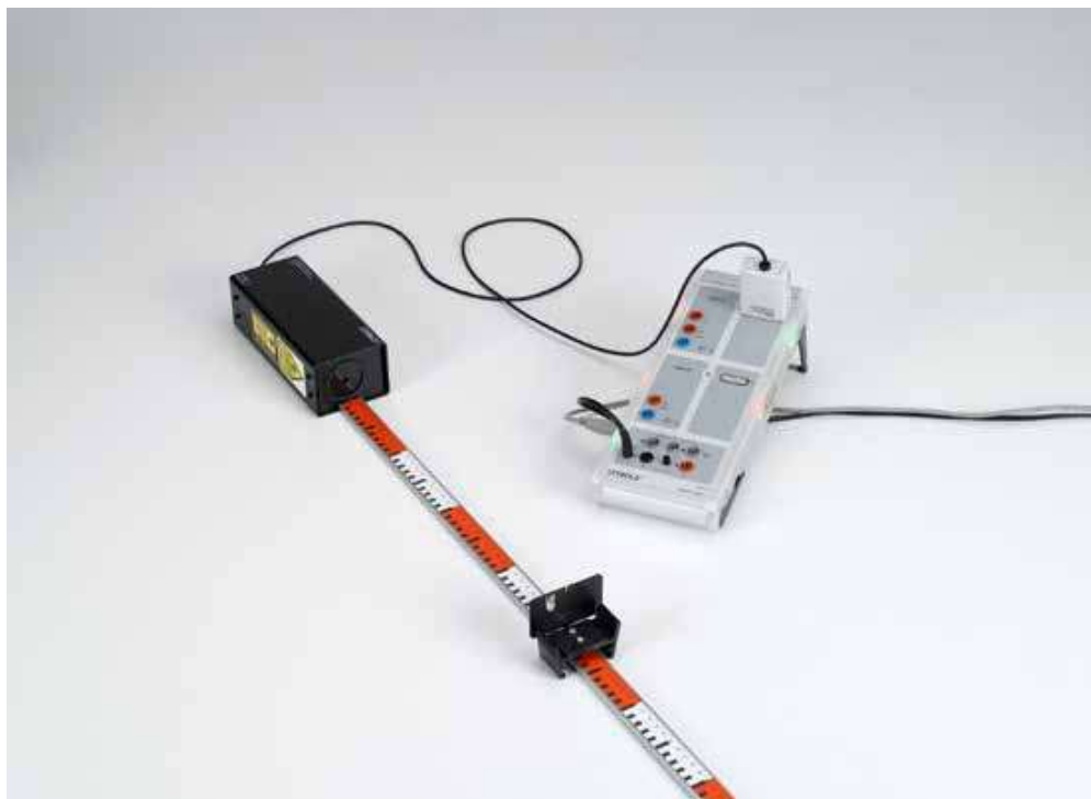
Determinación de la velocidad de la luz con una señal luminosa periódica en una distancia de medición corta - Medición con sensor de movimiento con láser S y CASSY (P5.6.3.3)
