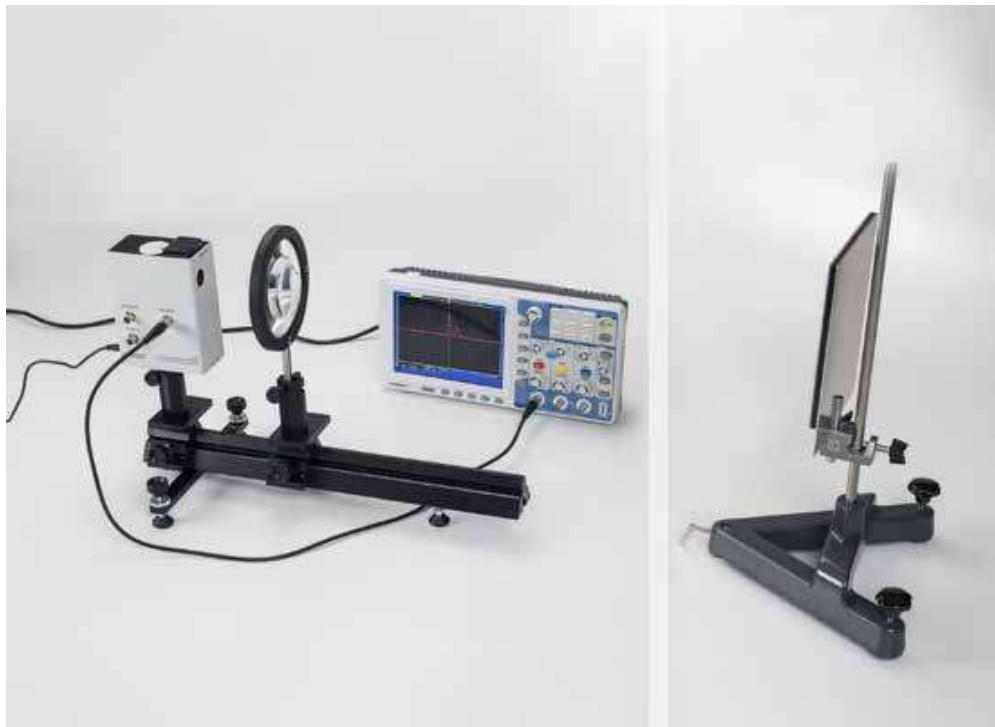
Determinación de la velocidad de la luz en el aire a partir del espacio y el tiempo recorridos por un pulso corto de luz (P5.6.2.1)
