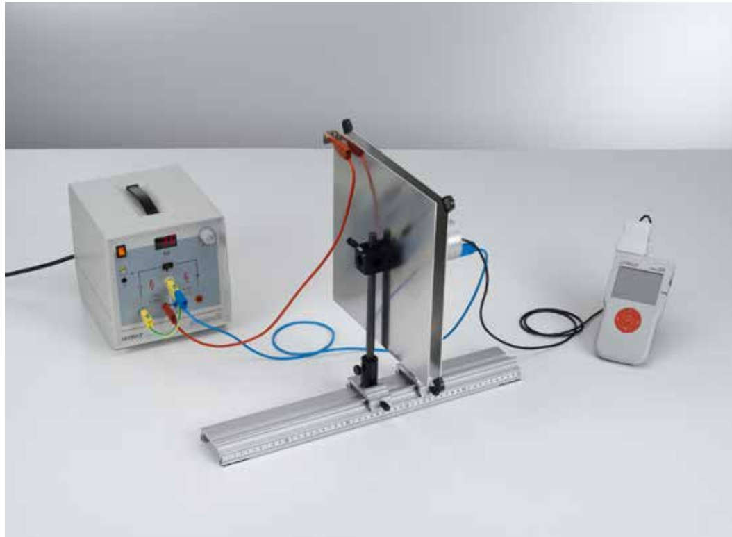
Medición de la intensidad de campo eléctrico dentro de un condensador de placas (P3.1.7.4)
