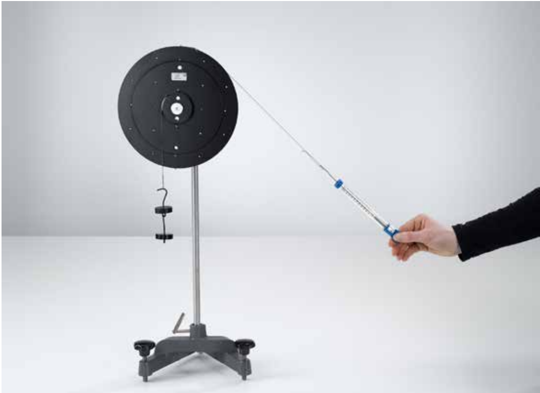
Rueda corrugada como palanca de brazos diferentes (P1.2.3.2)
