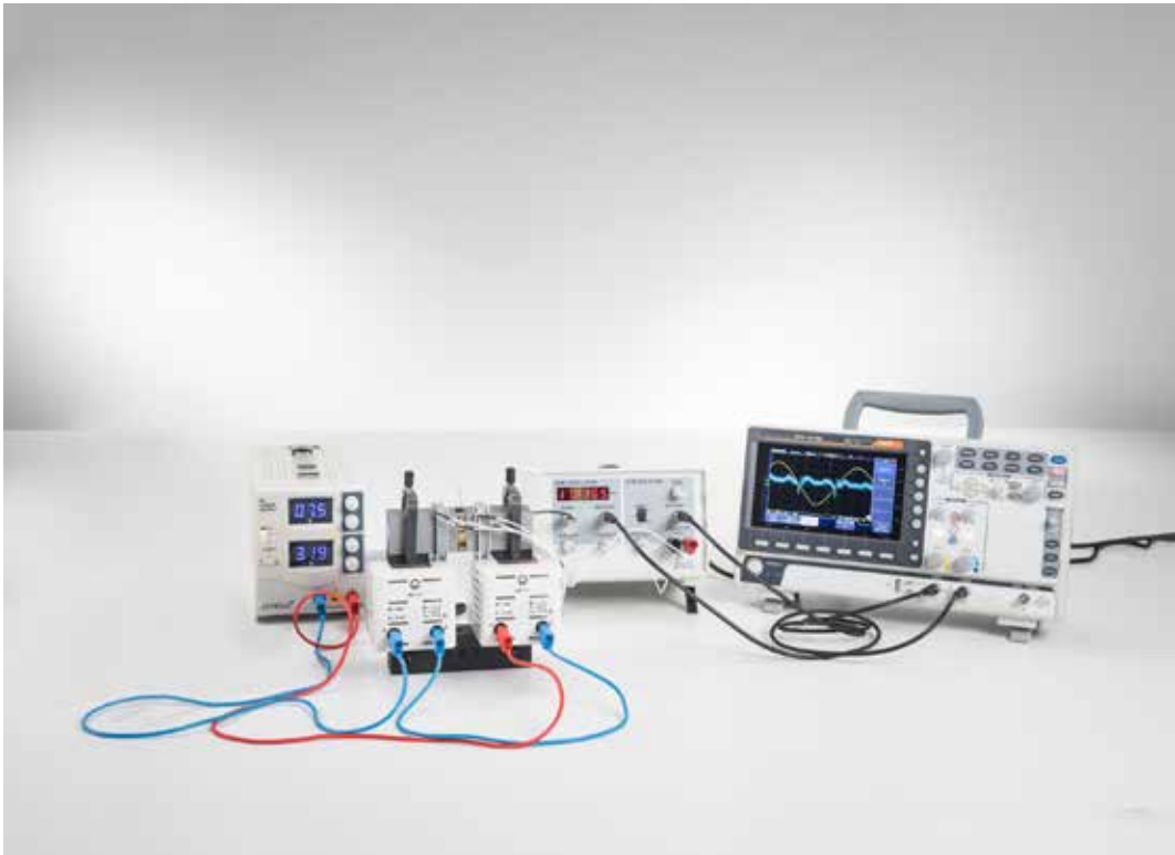
Resonancia magnética nuclear en poliestireno, glicerina y teflón (P6.5.3.1)
