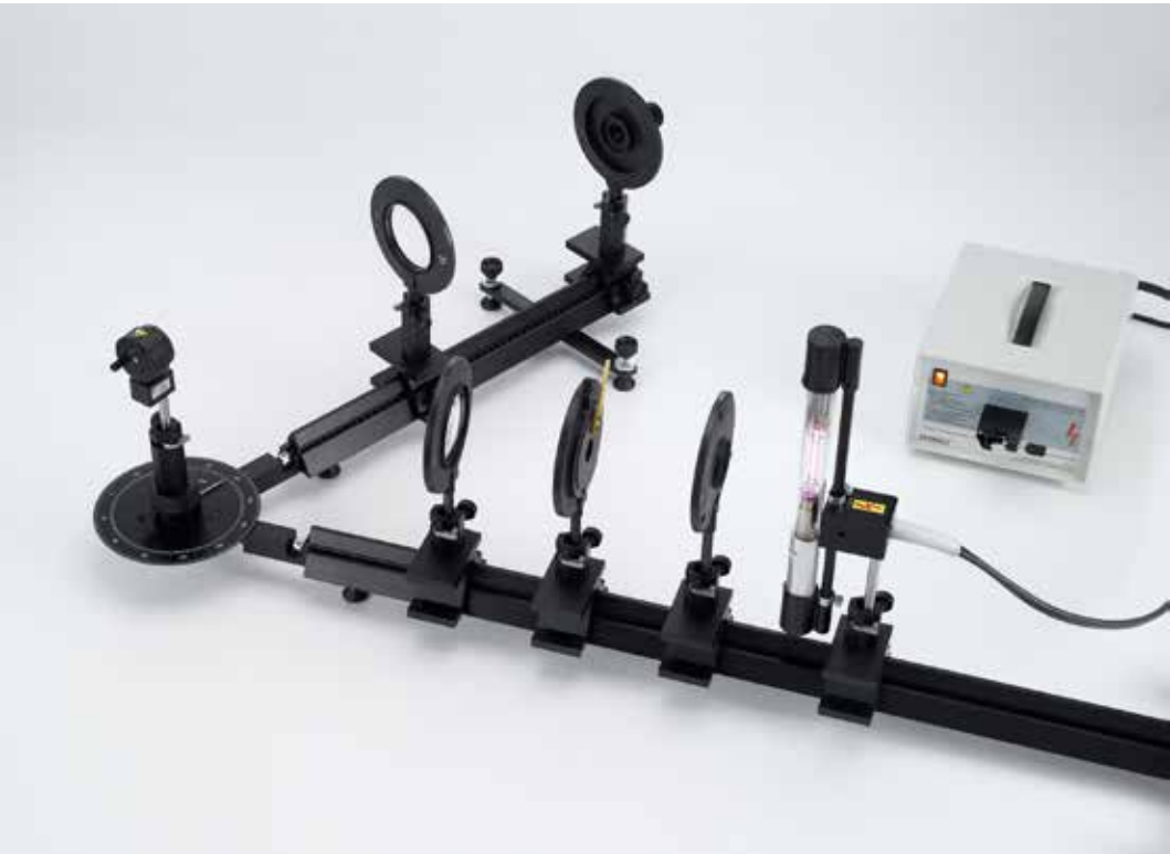
Observación del desdoblamiento de la serie de Balmer, utilizando hidrógeno deuterizado (Desdoblamiento de isótopos) - Observación de la división de línea con una construcción del telescopio (P6.2.1.5)
