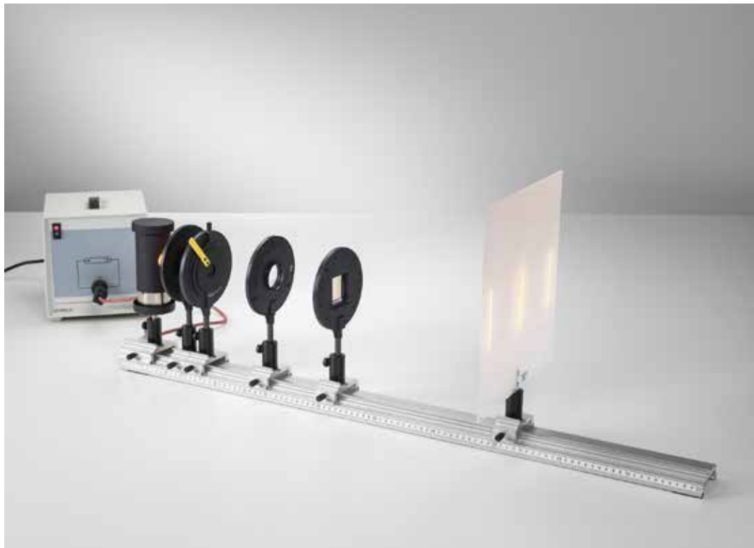
Representación de los espectros de líneas de gases nobles y de vapores metálicos (P6.2.2.1)
