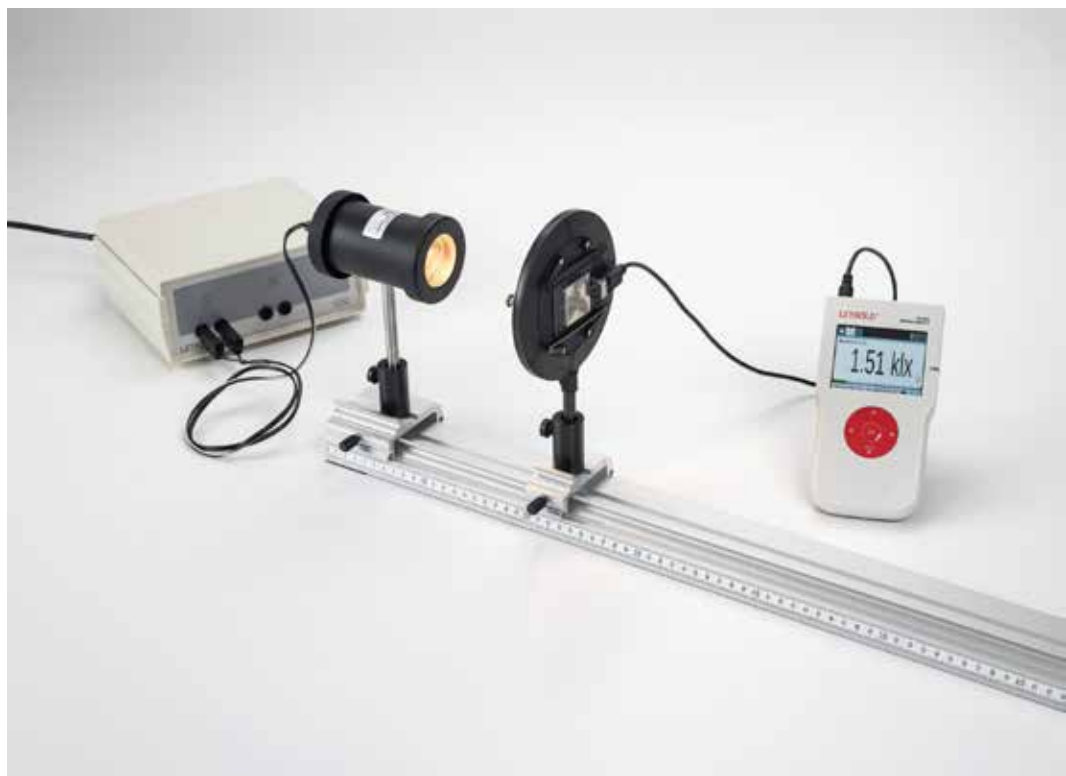
Determinación de la intensidad luminica en función de la distancia a la fuente luminosa - Medición con Mobile-CASSY (P5.5.1.2)
