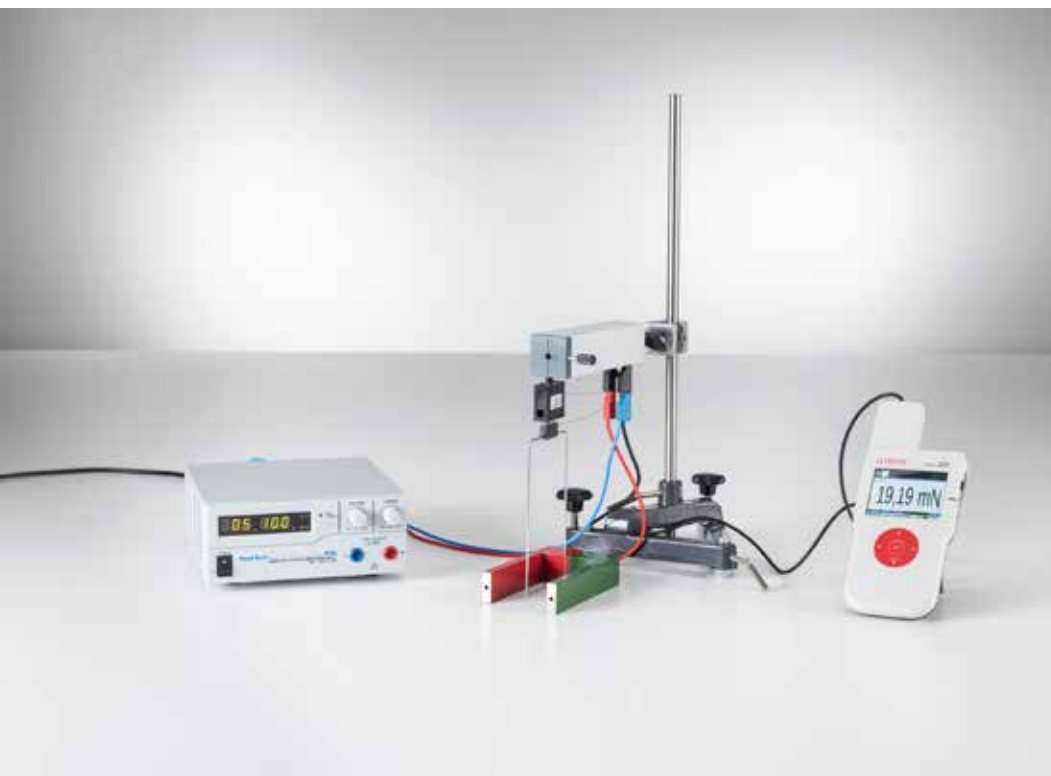
Medición de la fuerza sobre conductores con corriente eléctrica en el campo de un imán de herradura (P3.3.3.1)
