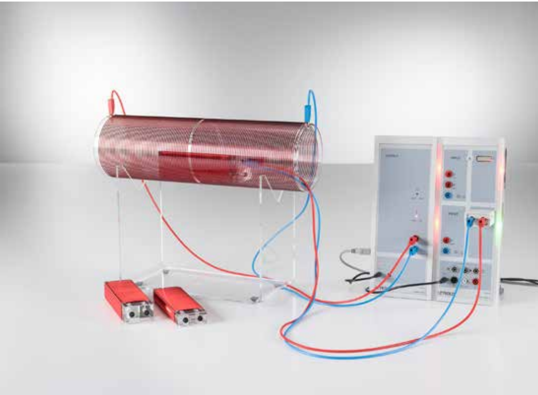
Medición de la tensión de inducción en un lazo conductor con un campo magnético variable - con Power-CASSY como fuente de corriente variable (P3.4.3.2)
