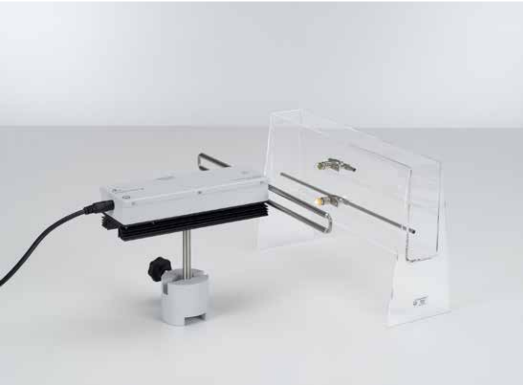
Estimación de las constantes dieléctricas del agua en el rango de las ondas decimétricas (P3.7.2.4)
