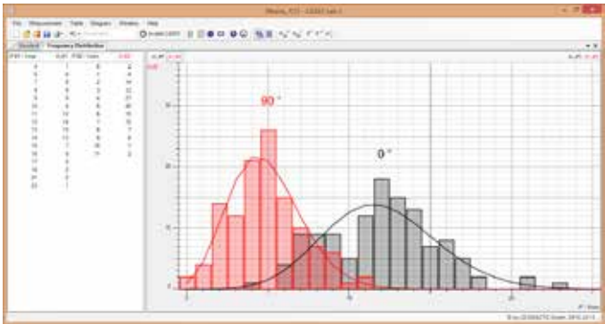
Distribución de la tasa de recuento para el detector de muones orientado en diferentes direcciones (P6.6.2.1)
