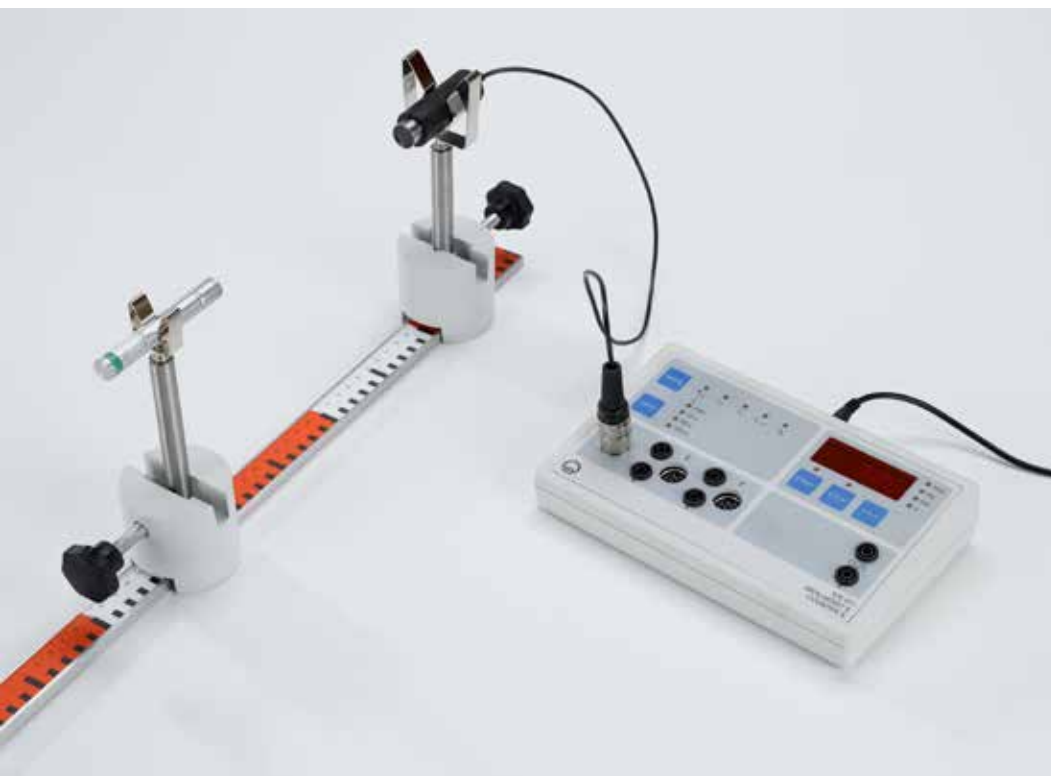
Confirmación de la ley de la distancia para la radiación \beta (P6.4.4.3)
