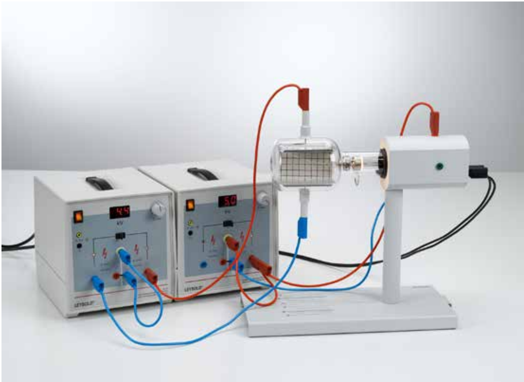
Estudio de la desviación de electrones en campos eléctricos y magnéticos (P3.8.5.1)
