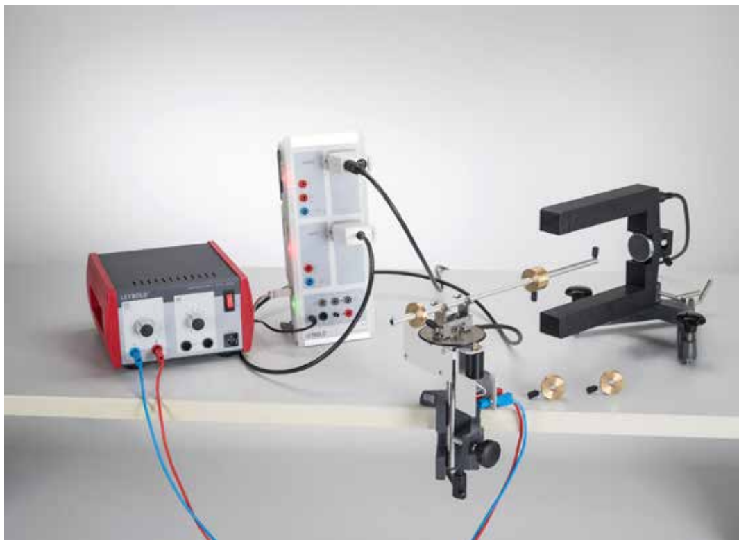
Fuerza centrífuga sobre un cuerpo en movimiento de rotación - Medición con el aparato de fuerza centrífuga y CASSY (P1.4.3.3)
