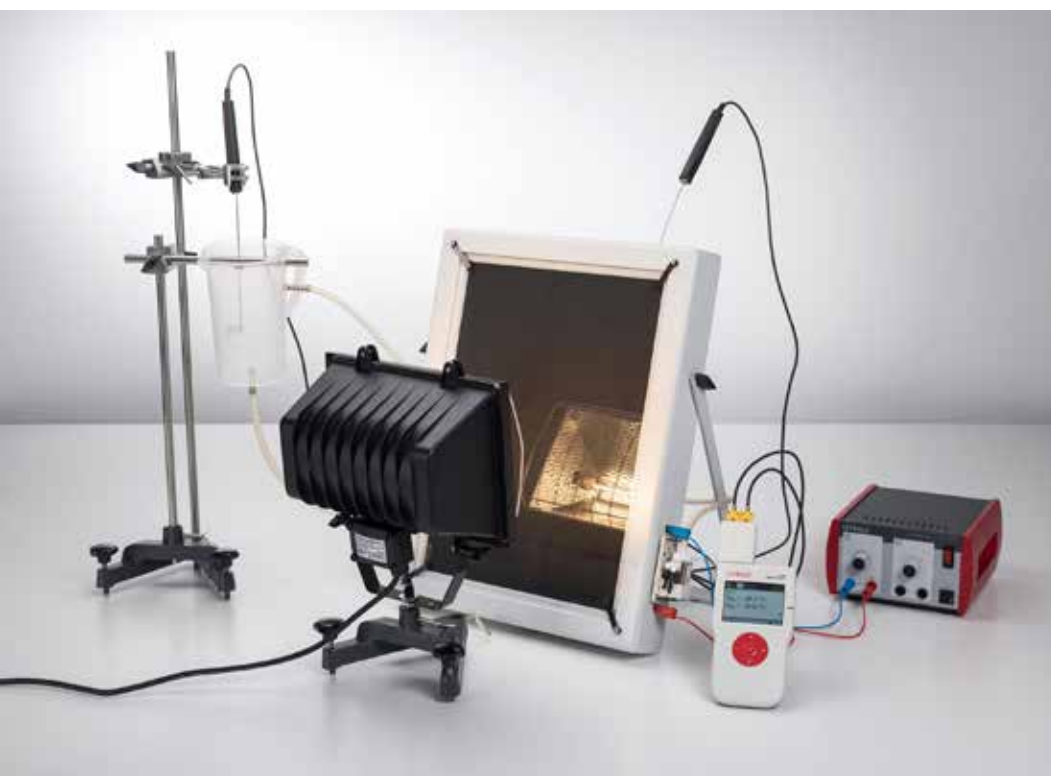
Eficiencia de un colector solar (P2.2.2.1)
