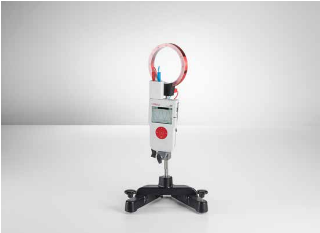
Medición del campo magnético terrestre con una bobina de inducción que gira y CASSY (P3.4.6.2)
