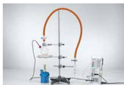
Registro de la curva de presión de vapor del agua - Presiones hasta 1 bar (P2.4.2.1).
