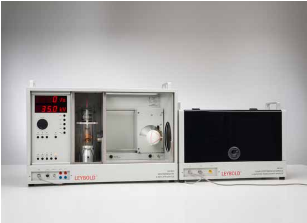
Medición y representación de una tomografía computarizada (P6.3.8.1)
