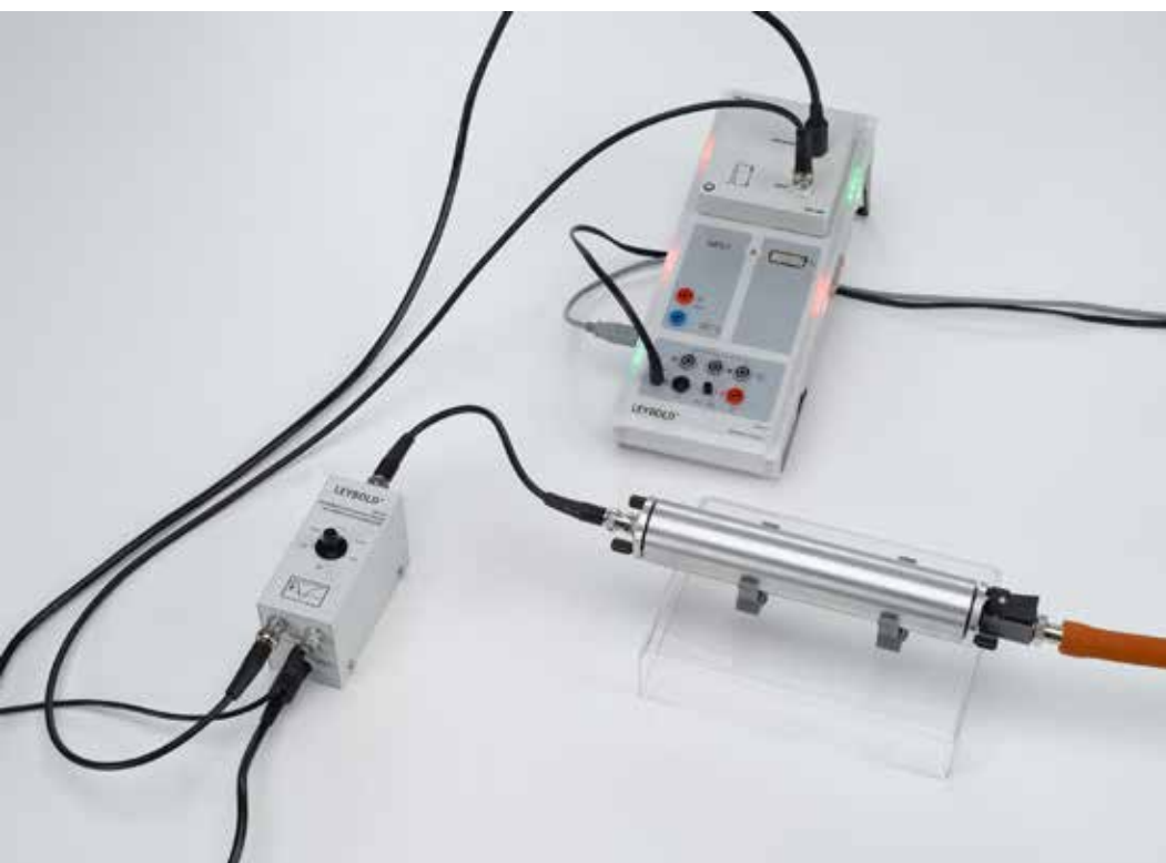
Espectroscopia \alpha en muestras radioactivas (P6.5.4.1)
