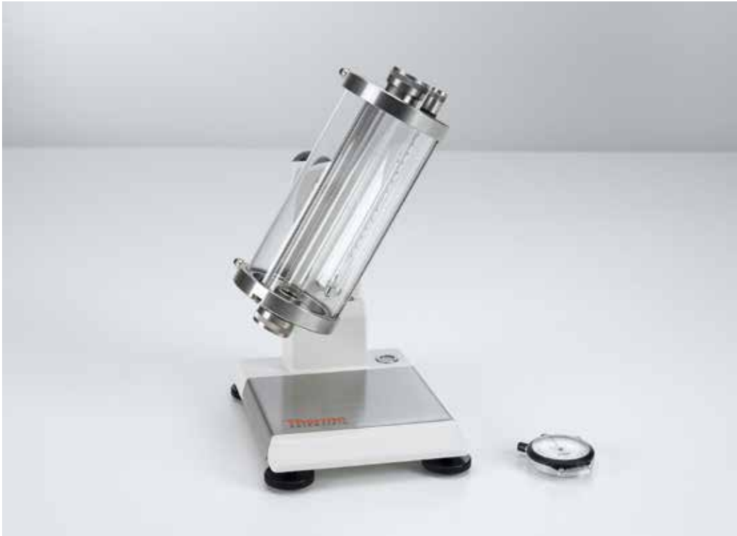
Viscosímetro de caída de bola de Höppler: Medición de la viscosidad de soluciones de azúcar en función de la concentración (P1.8.3.2)
