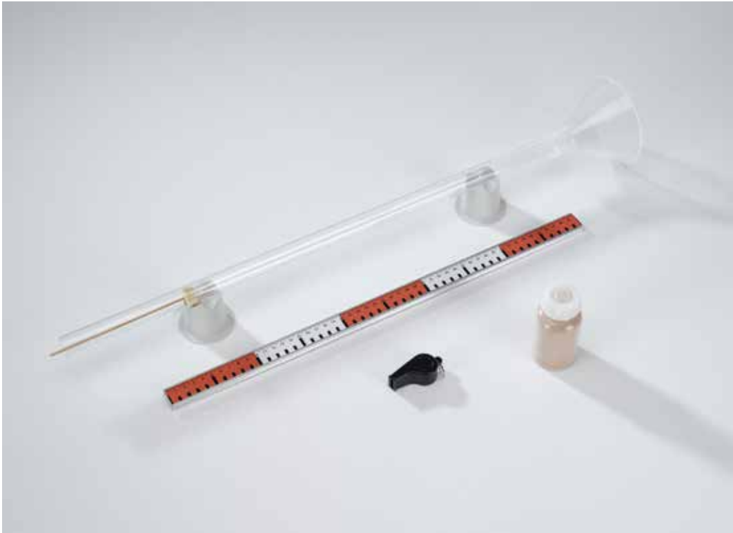
Tubo de Kundt: Determinación de la longitud de onda con el método del polvo de corcho (P1.7.3.1)
