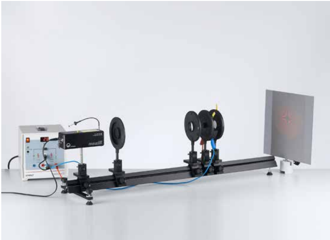
Demostración del efecto Pockels en un trayecto conoscópico de un rayo (P5.4.5.1)
