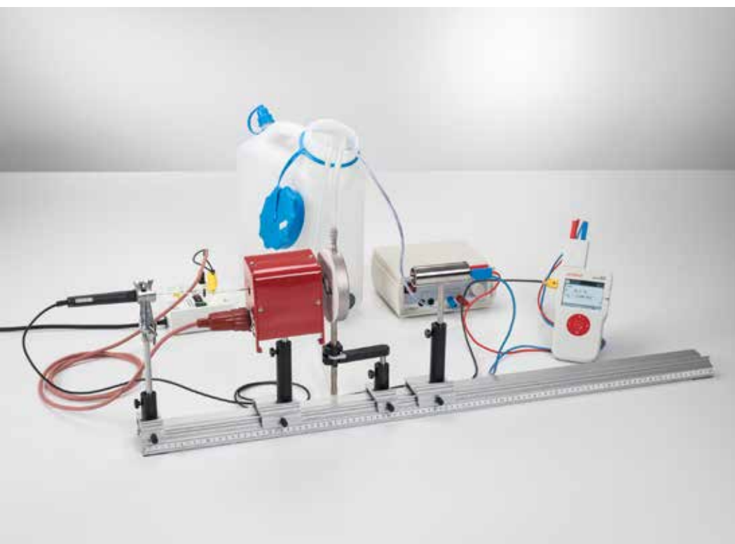
Confirmación de la ley de Stefan-Boltzmann midiendo la intensidad de la radiación de un „cuerpo negro” en función de su temperatura (P5.5.2.1)
