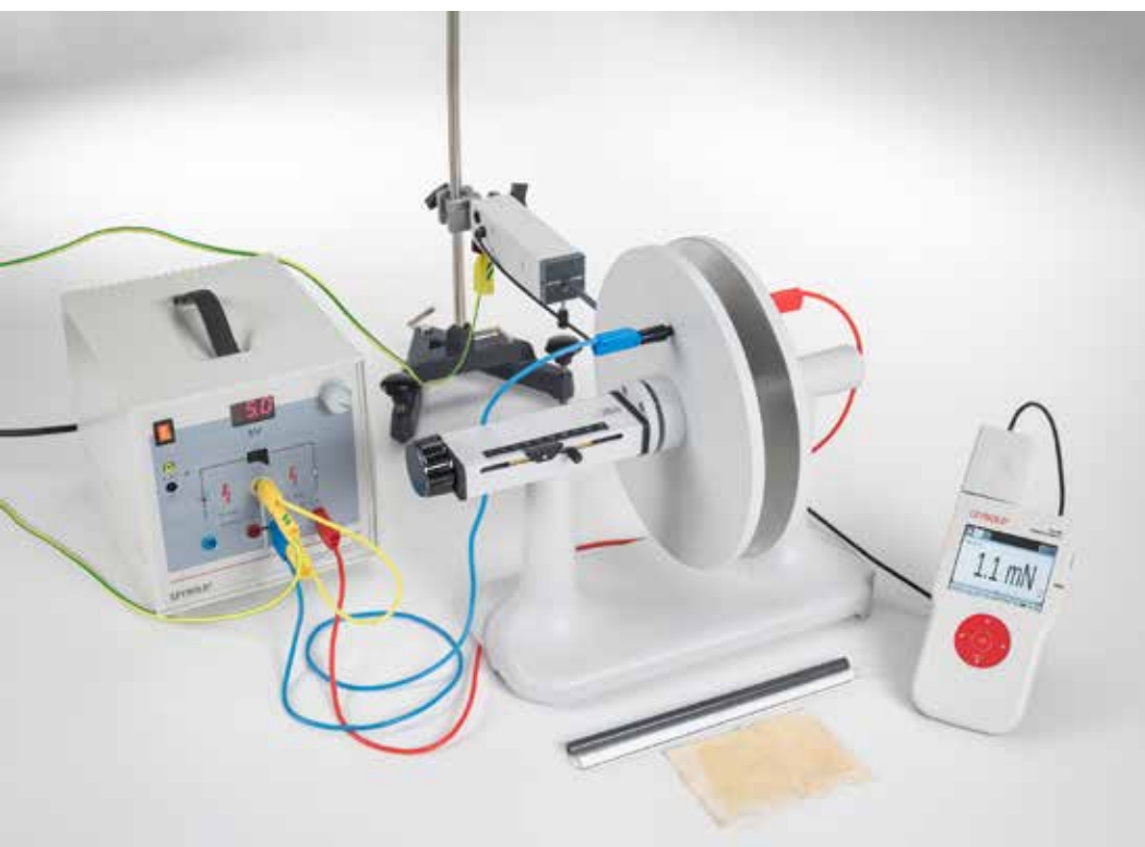
Medición de la fuerza sobre una carga eléctrica en un campo eléctrico homogéneo - Medición con el sensor de fuerzas (P3.1.4.4)
