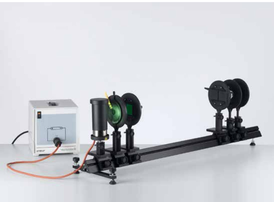
Estudio de la coherencia espacial de una fuente luminosa extendida (P5.3.1.9)
