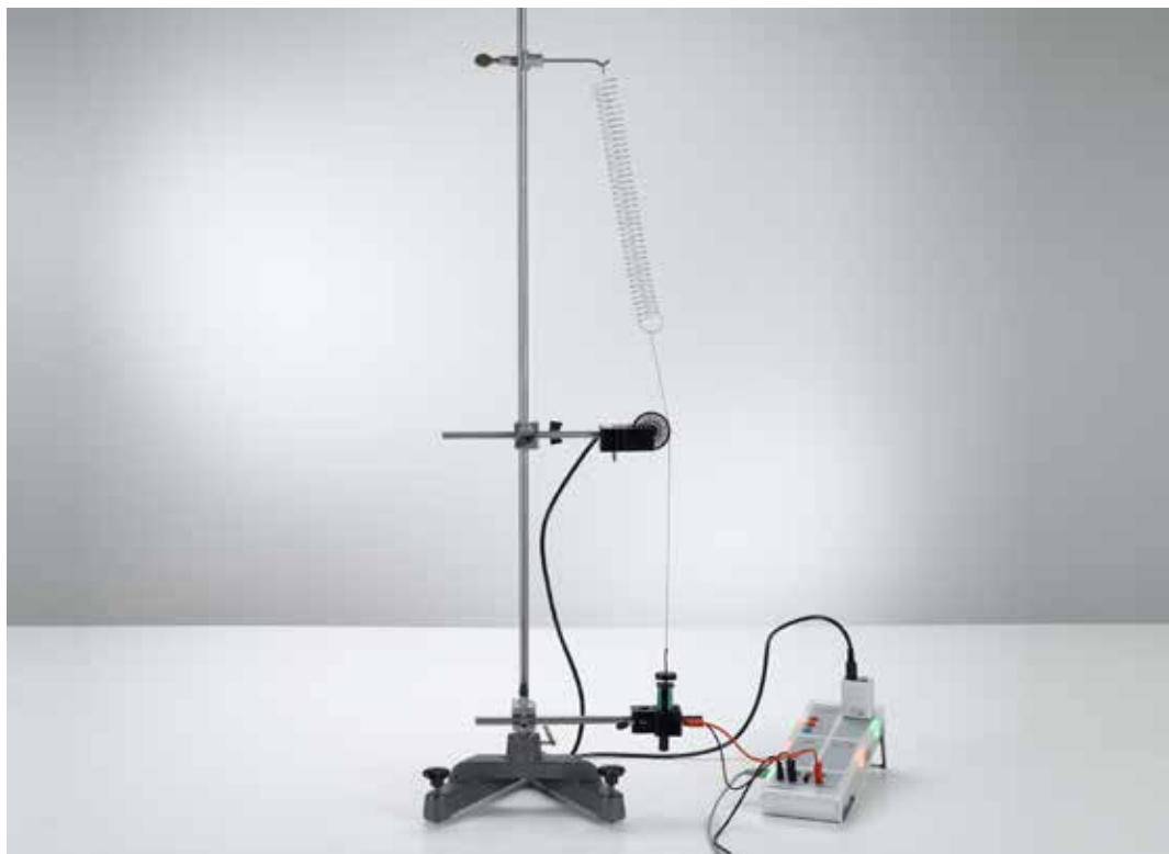
Oscilaciones de un péndulo de resorte y determinación del periodo de un péndulo de resorte en función de la masa oscilante - Medición con CASSY (P1.5.2.1)
