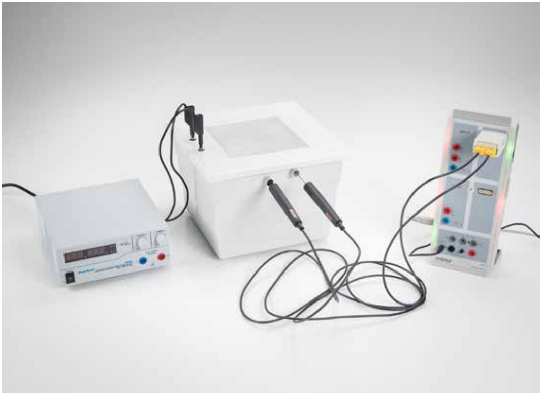
Determinación de la conductividad térmica de materiales de construcción según el método de placa simple (P2.2.1.1)
