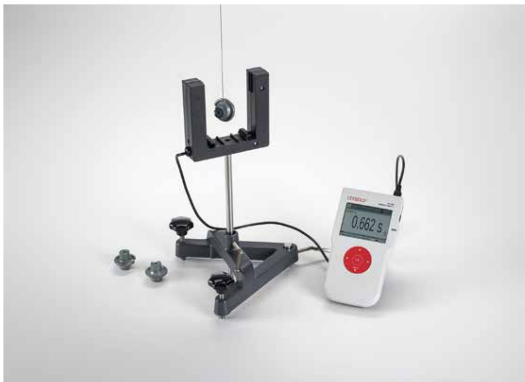
Determinación de la aceleración de la gravedad con un péndulo matemático - Medición con barrera luminosa (P1.5.1.7)
