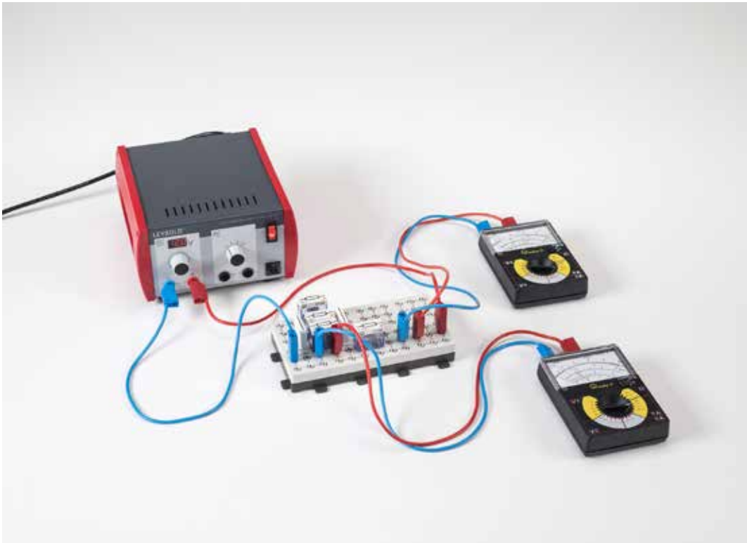
El amperímetro como resistencia óhmica en un circuito (P3.2.4.1)
