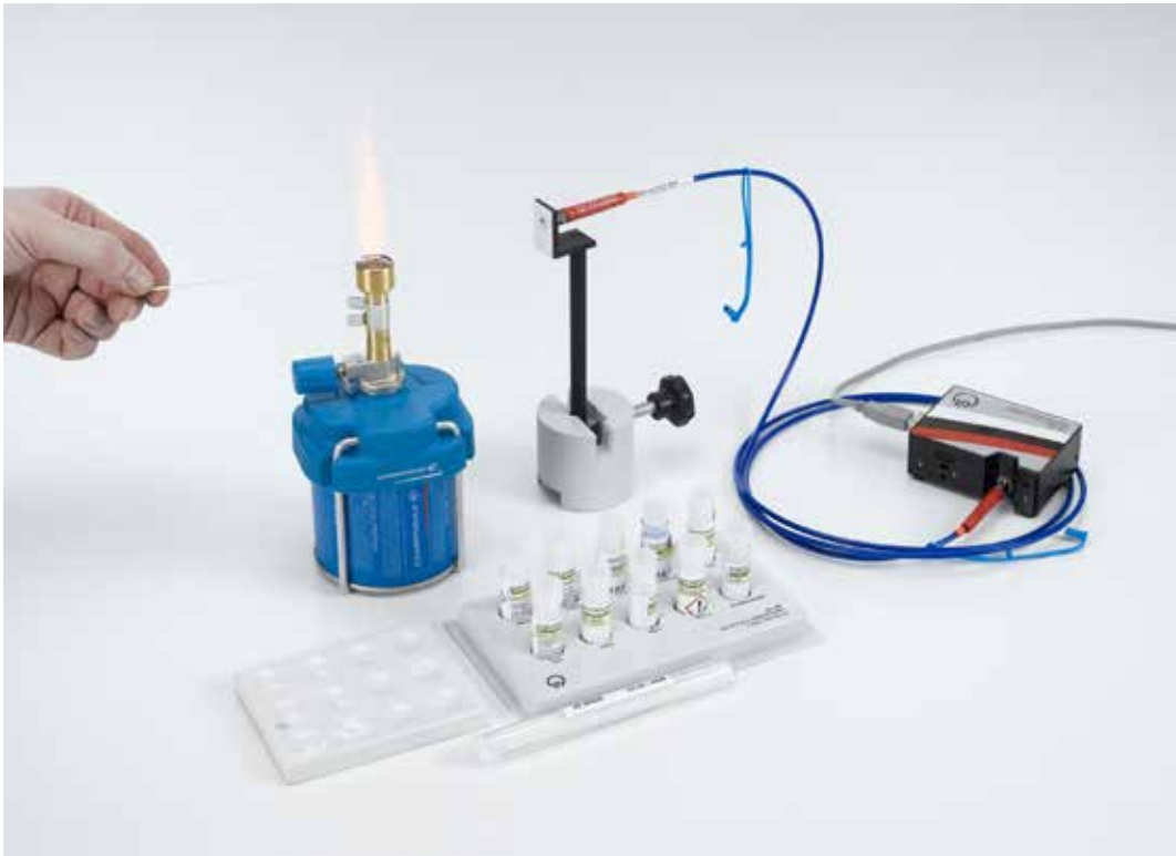
Registro del espectro de emisión de una coloración de flama (P6.2.2.4)
