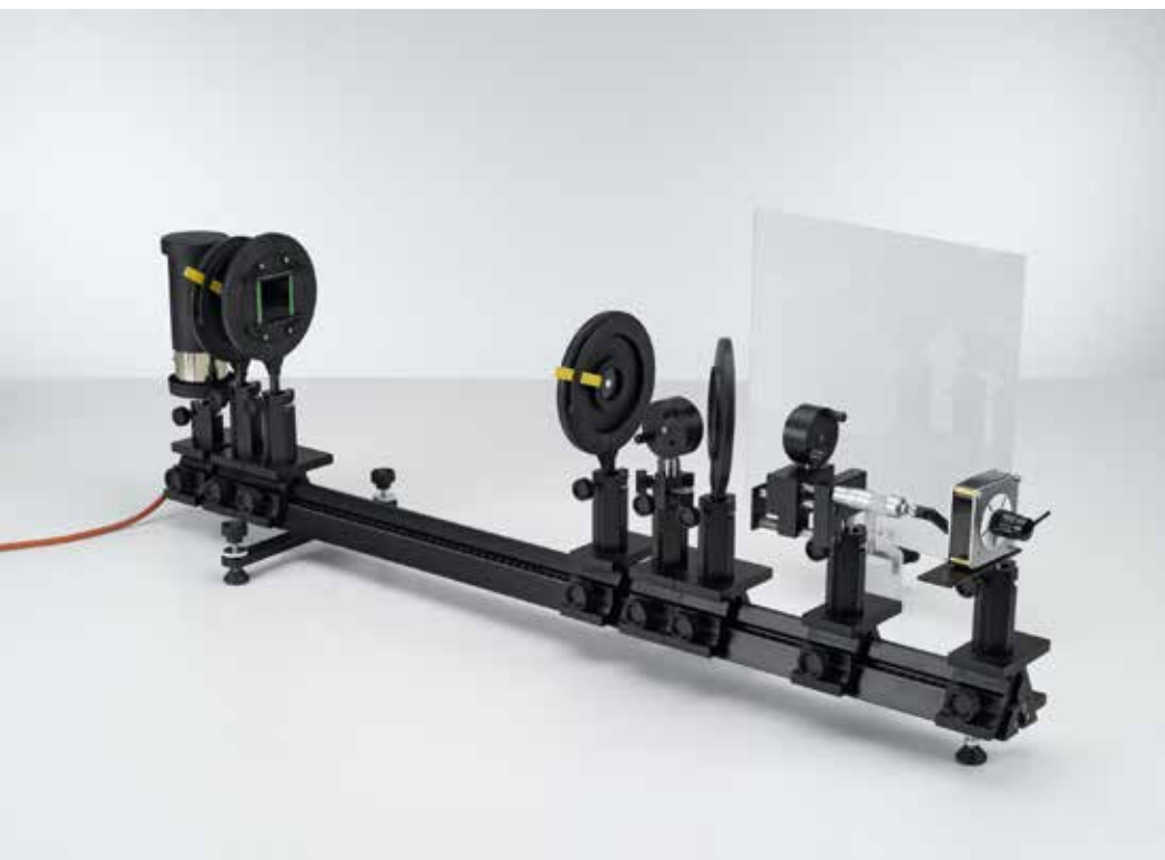
Determinación de la coherencia temporal y la anchura de líneas espectrales con un interferómetro de Michelson (P5.3.4.4)
