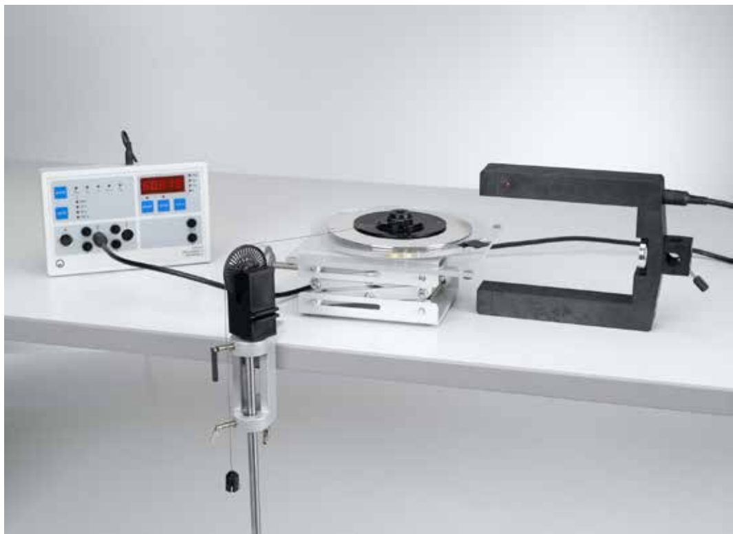
Diagramas del recorrido de tiempo de movimientos giratorios – Medición del tiempo con el contador (P1.4.1.1)
