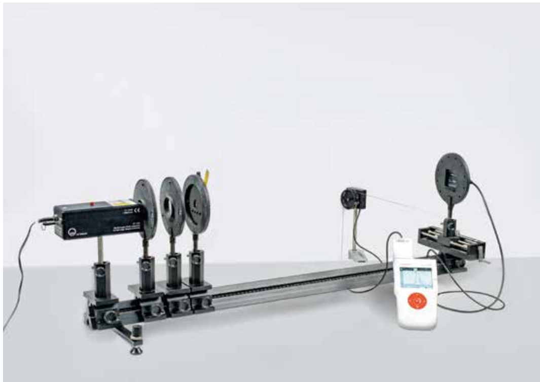
Difracción en una rendija simple - Registro y evaluación con CASSY (P5.3.1.4)
