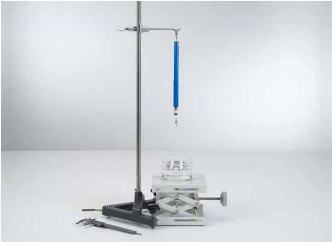
Medición de la tensión superficial por el método de ruptura (P1.8.4.1)
