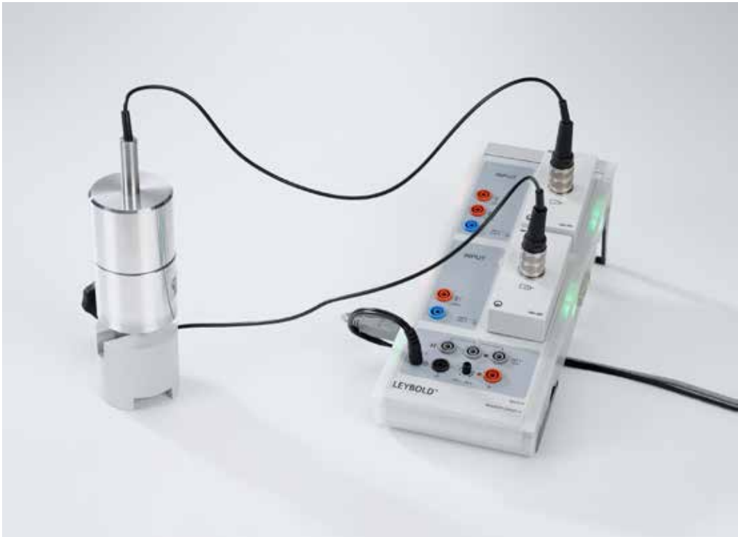
Detección de muones (P6.6.2.1)
