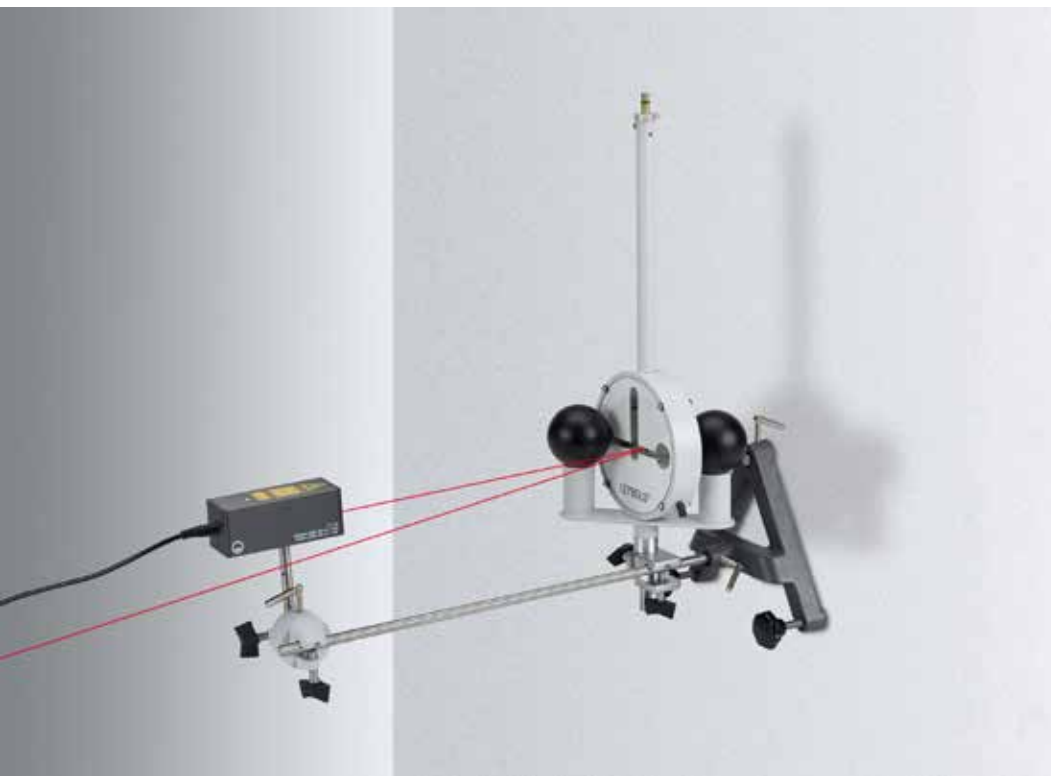
Determinación de la constante de gravitación con la balanza de torsión de Cavendish - Medición de las desviaciones con indicador luminoso (P1.1.3.1)
