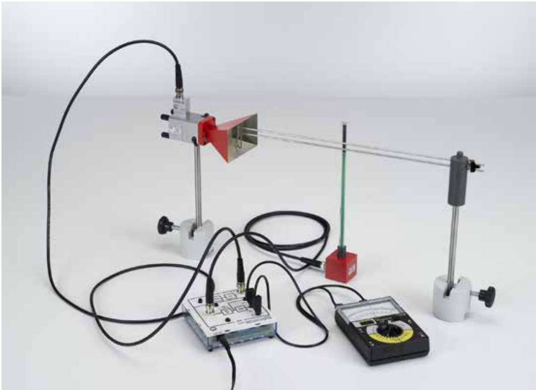
Conducción de microondas a lo largo de una línea de Lecher (P3.7.5.1)
