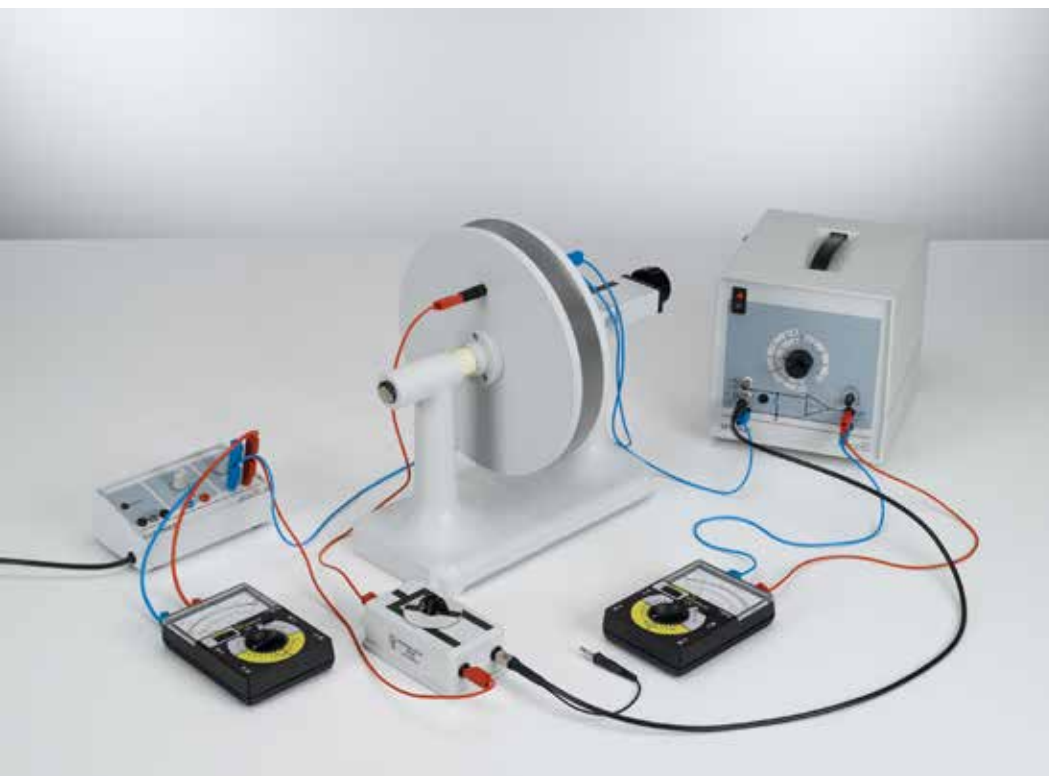
Determinación de la capacitancia de un condensador de placas - Medición de la carga con el amplificador D de medida I (P3.1.7.3)
