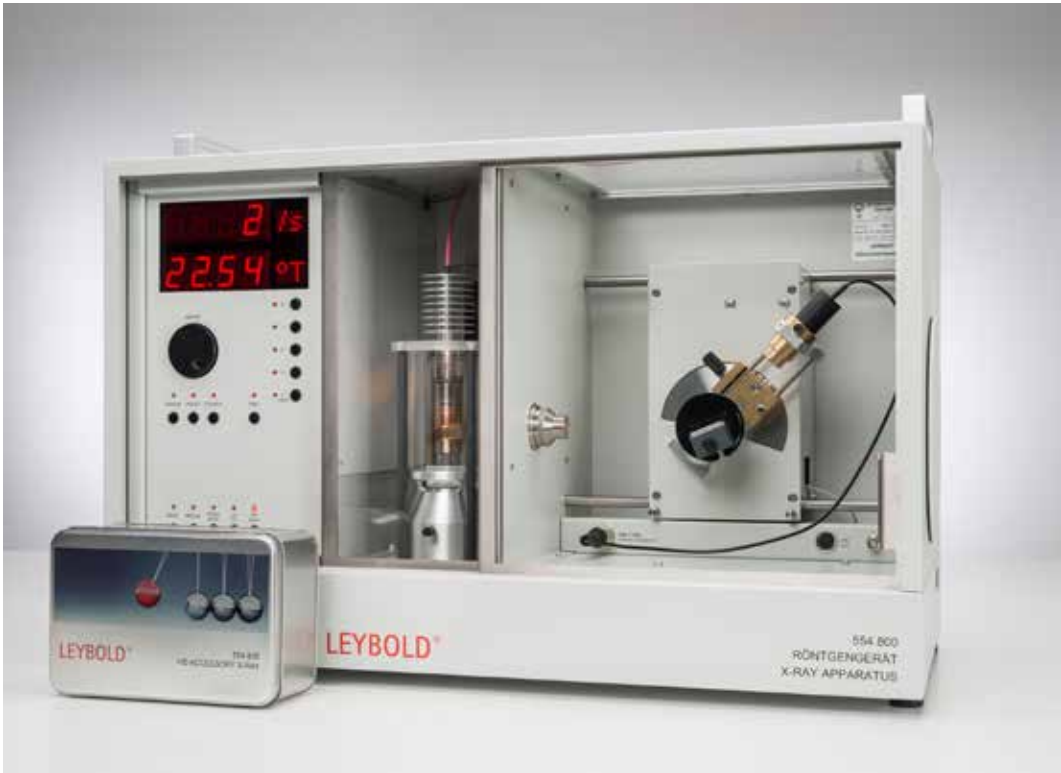
Estructura fina en alta resolución de los rayos X característicos de un ánodo de molibdeno (P6.3.6.11)
