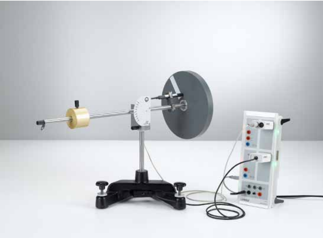
Precesión y nutación del giroscopio (P1.4.4.3)
