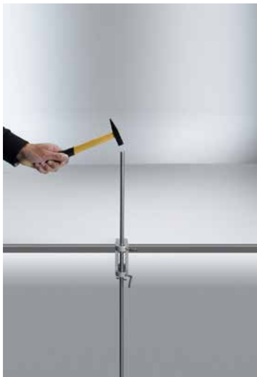
Determinación de la velocidad del sonido en sólidos (P1.7.3.5)
