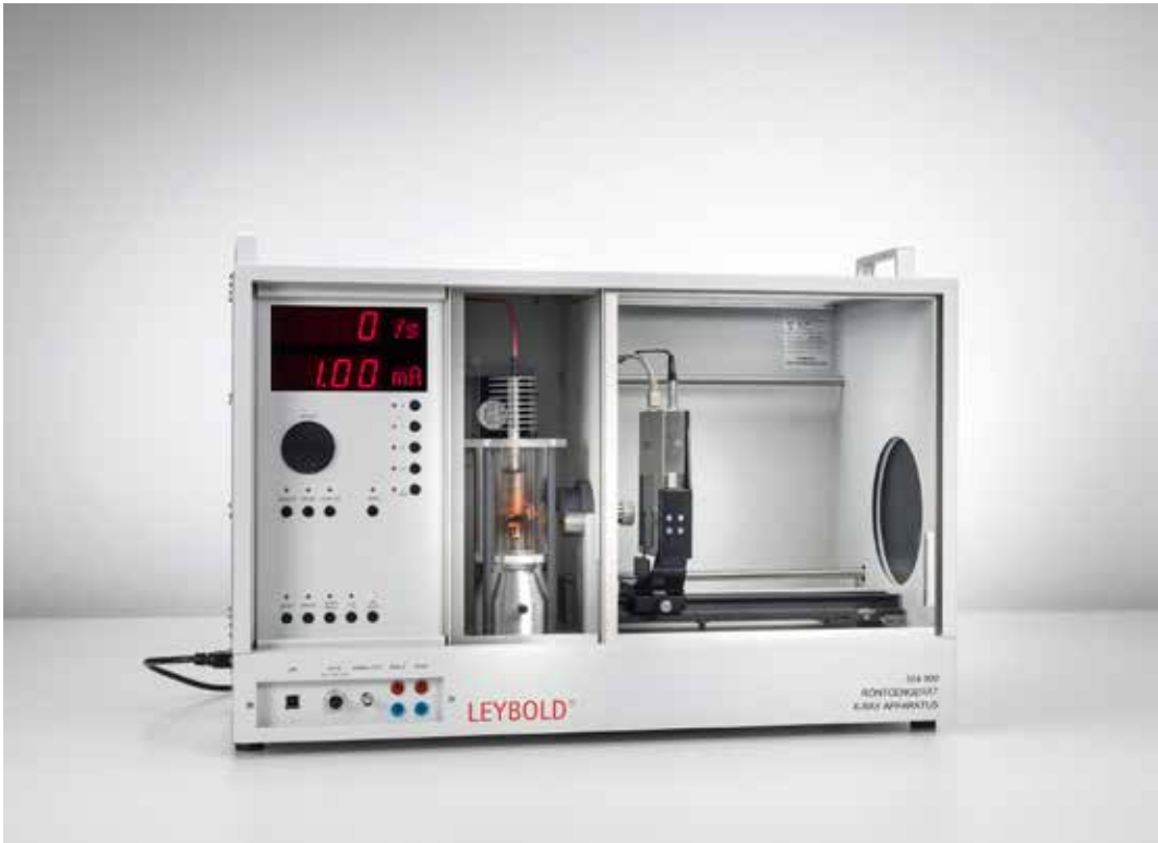
Diagrama digital de Laue: Investigación de la red cristalina de monocristales (P7.1.2.5)
