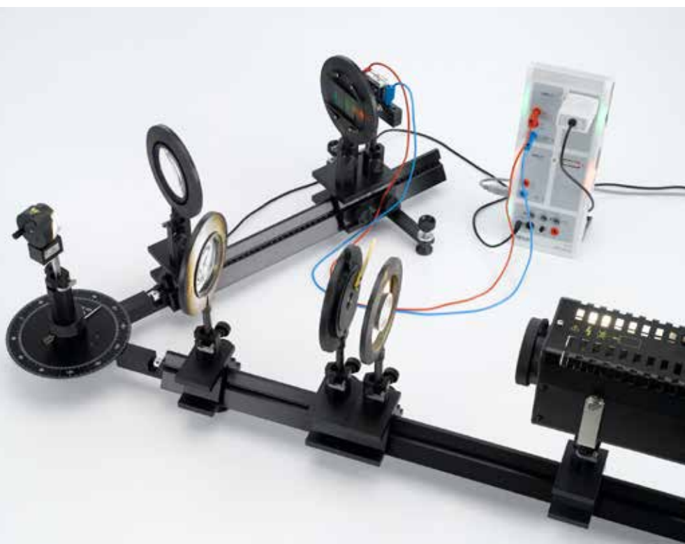
Investigación del espectro de una lámpara de Xenon mediante la rejilla holográfica (P5.7.2.5)
