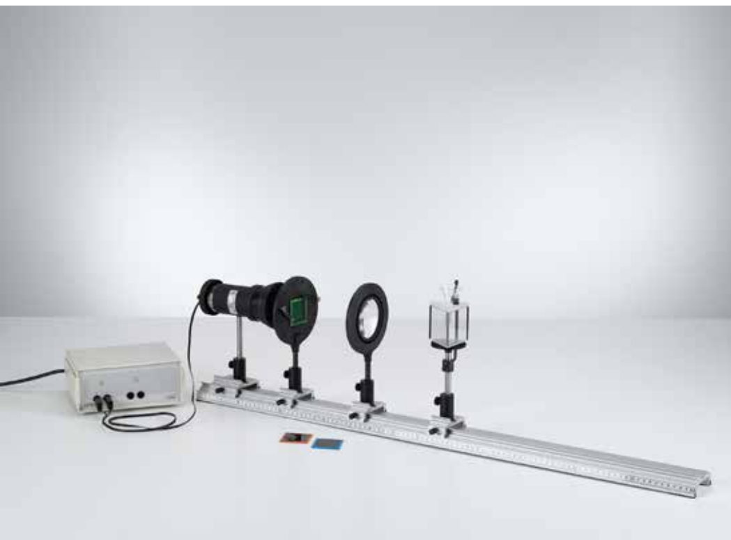
Determinación del índice de refracción y de la dispersión en líquidos (P5.2.1.2)
