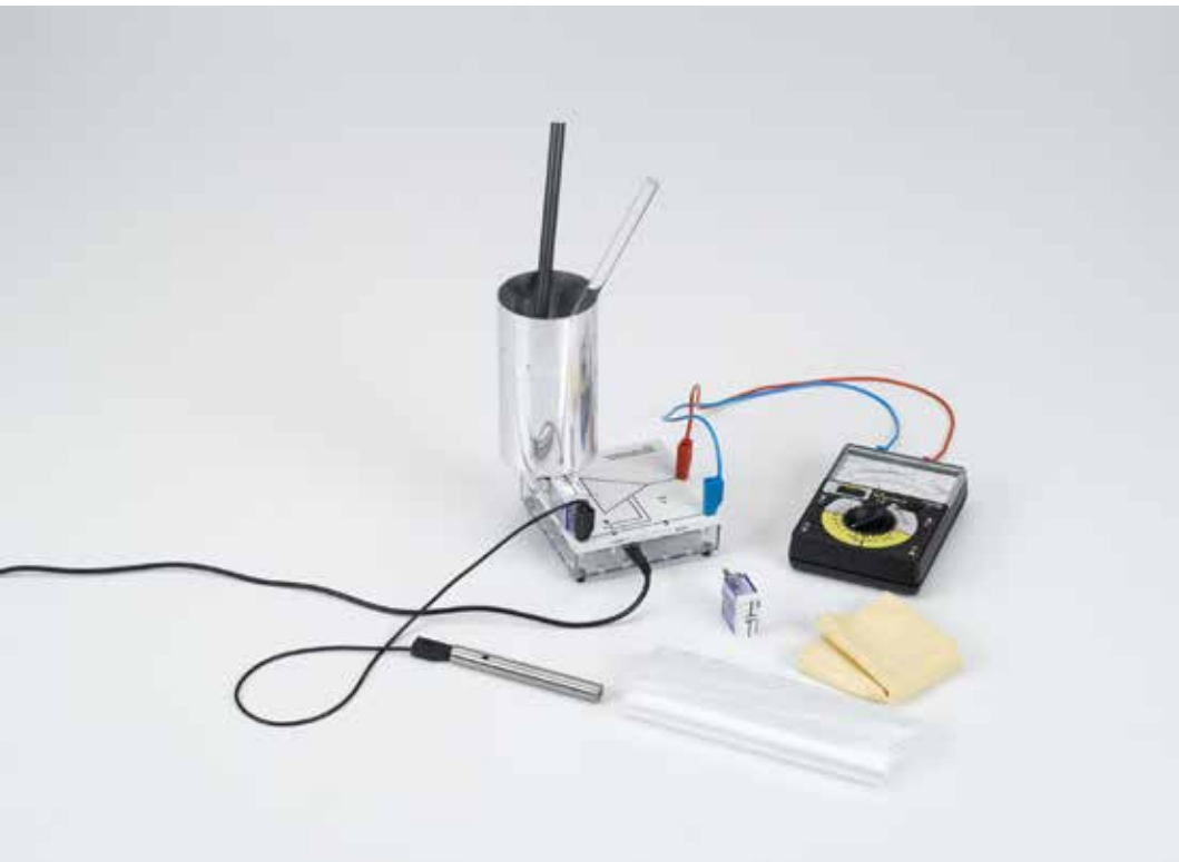
Experimentos básicos de electrostática con el electrómetro amplificador (P3.1.1.2)
