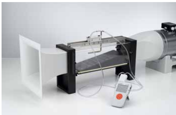
Verificación de la ecuación de Bernoulli - Medición con un sensor de presión y Mobile-CASSY (P1.8.7.4)
