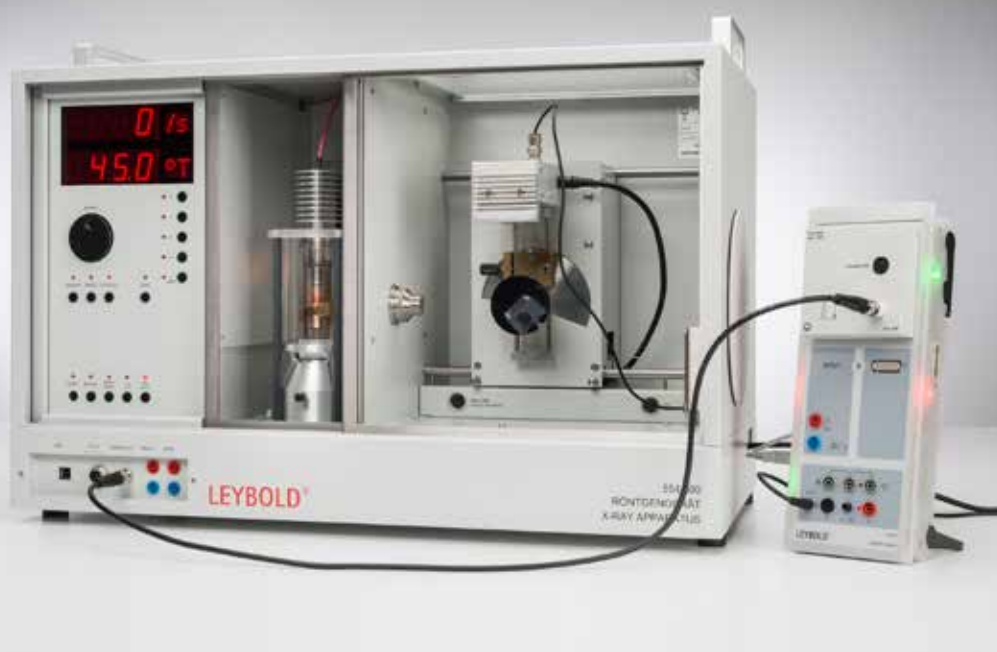
Efecto Compton: Medición de la energía de los fotones dispersados en función del ángulo de dispersión (P6.3.7.2)
