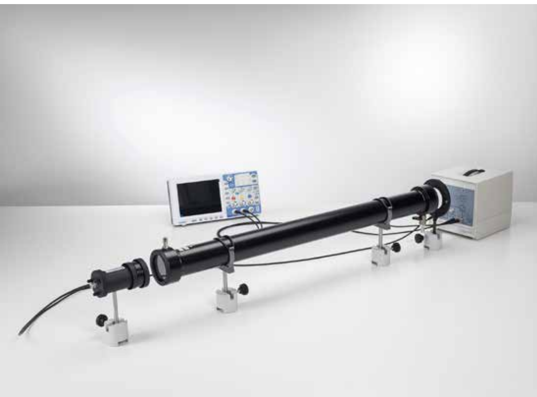
Determinación de la velocidad de la luz en diferentes medios de propagación (P5.6.3.2)
