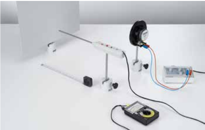
Determinación de la longitud de onda de las ondas sonoras estacionarias (P1.7.3.2)
