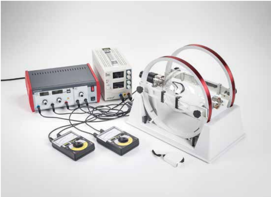
Determinación de la carga específica del electrón (P6.1.3.1)
