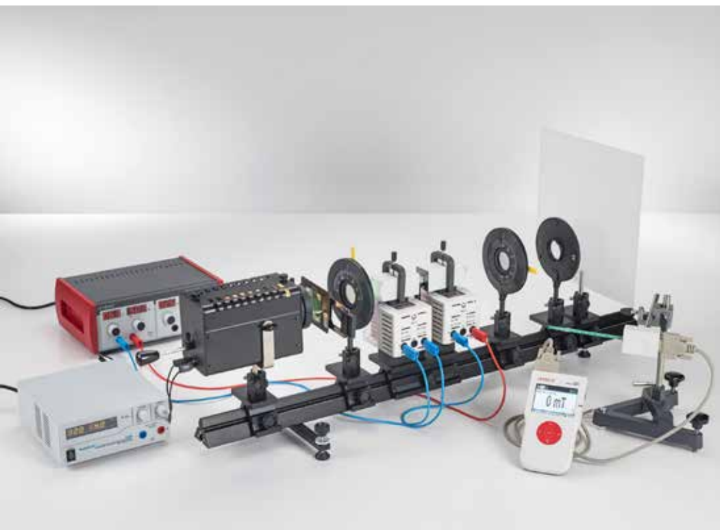
Efecto Faraday: Determinación de la constante de Verdet para vidrio Flint en función de la longitud de onda (P5.4.6.1)
