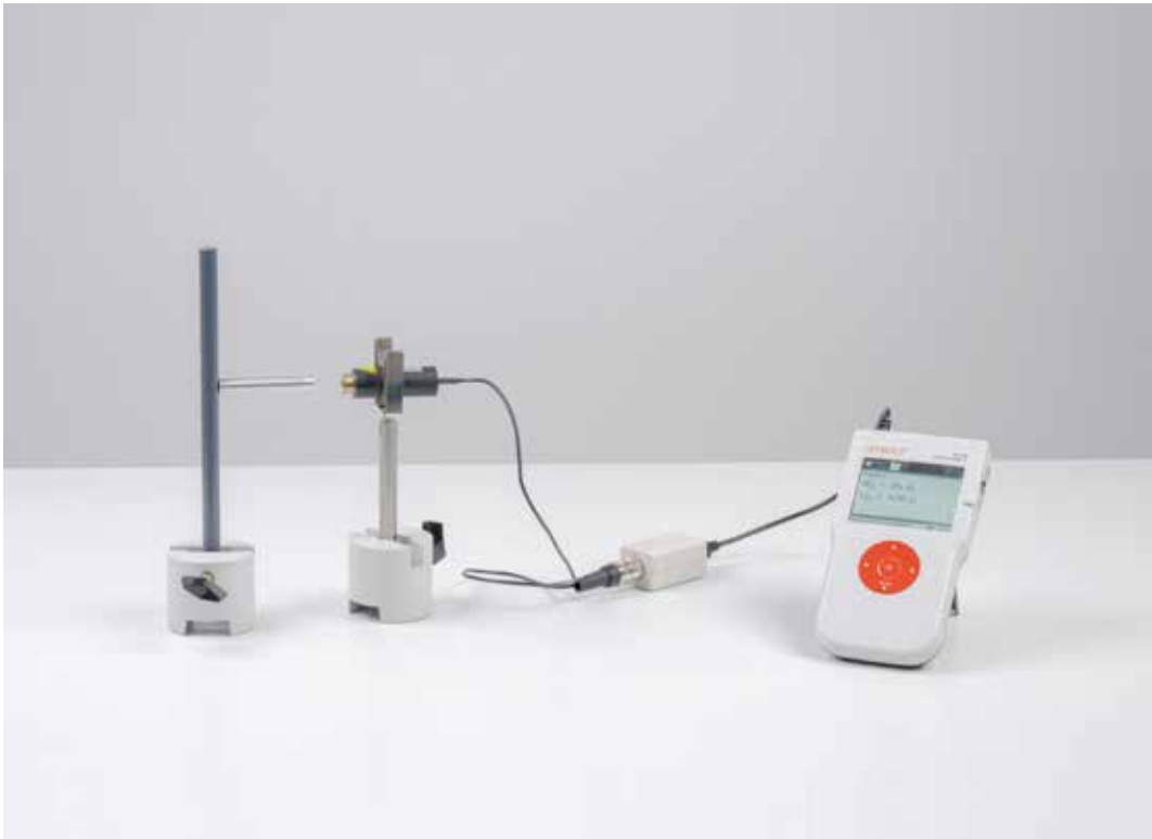
Registro de la curva característica de un tubo contador Geiger-Müller (P6.4.1.4)
