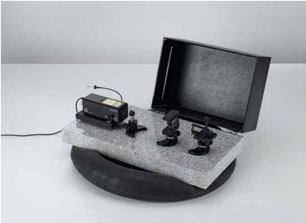
Elaboración de hologramas de reflexión con luz blanca sobre la placa base para óptica con láser (P5.3.6.1)
