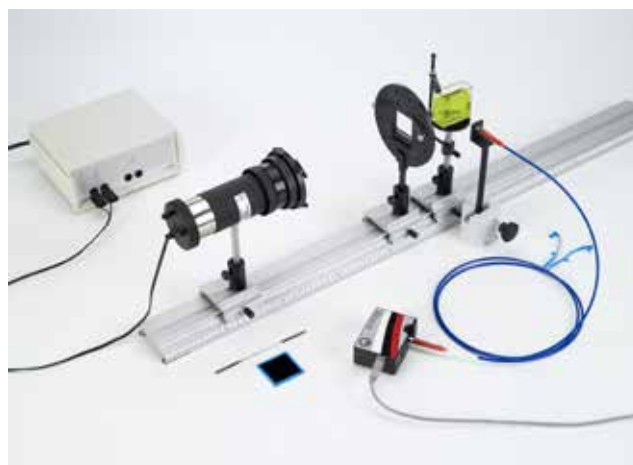
Espectros de absorción et de fluorescencia de líquidos coloreados (P5.2.4.4)
