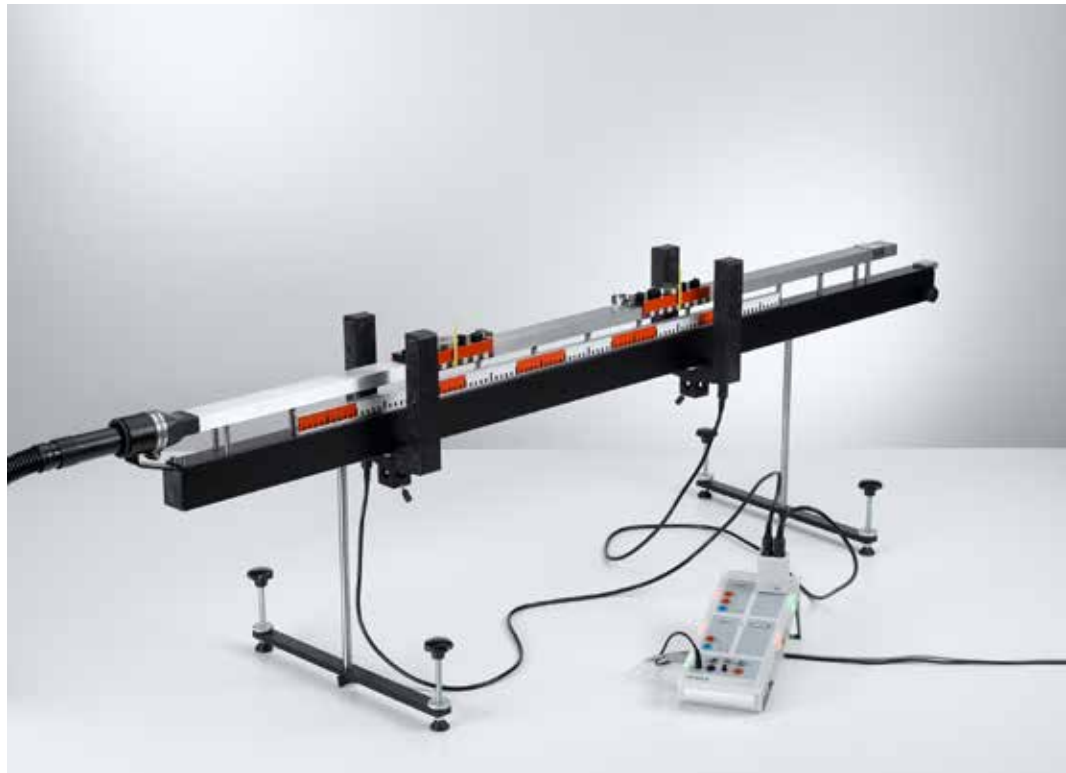
Energía y cantidad de movimiento en un choque elástico e inelástico sobre el carril de cojín de aire - Medición con dos barreras luminosas y CASSY (P1.3.4.8)
