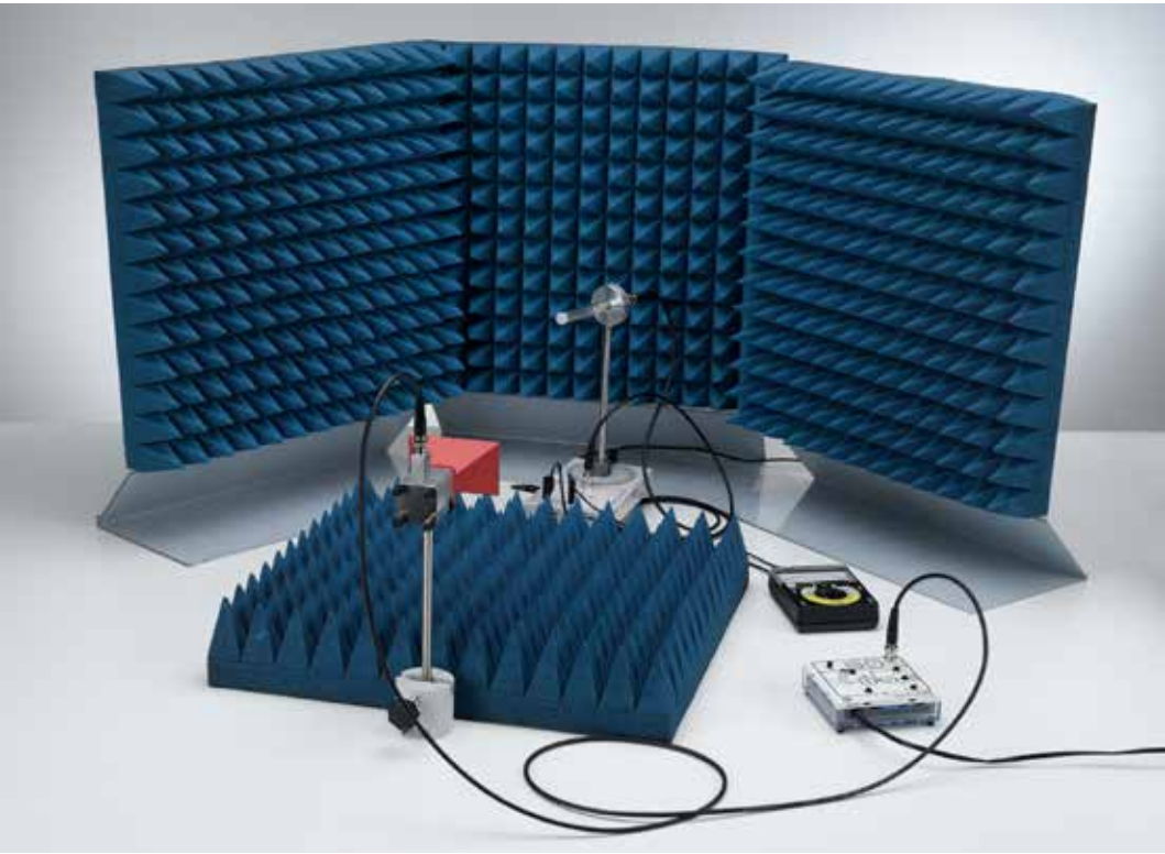
Características direccionales de una antena de hélice - Registro a pulso (P3.7.6.1)
