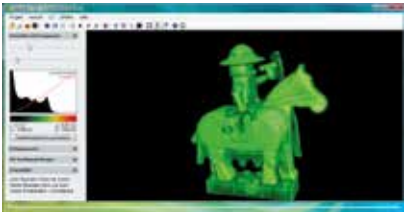
Tomografía computarizada de una figura de Lego (P6.3.8.2)
