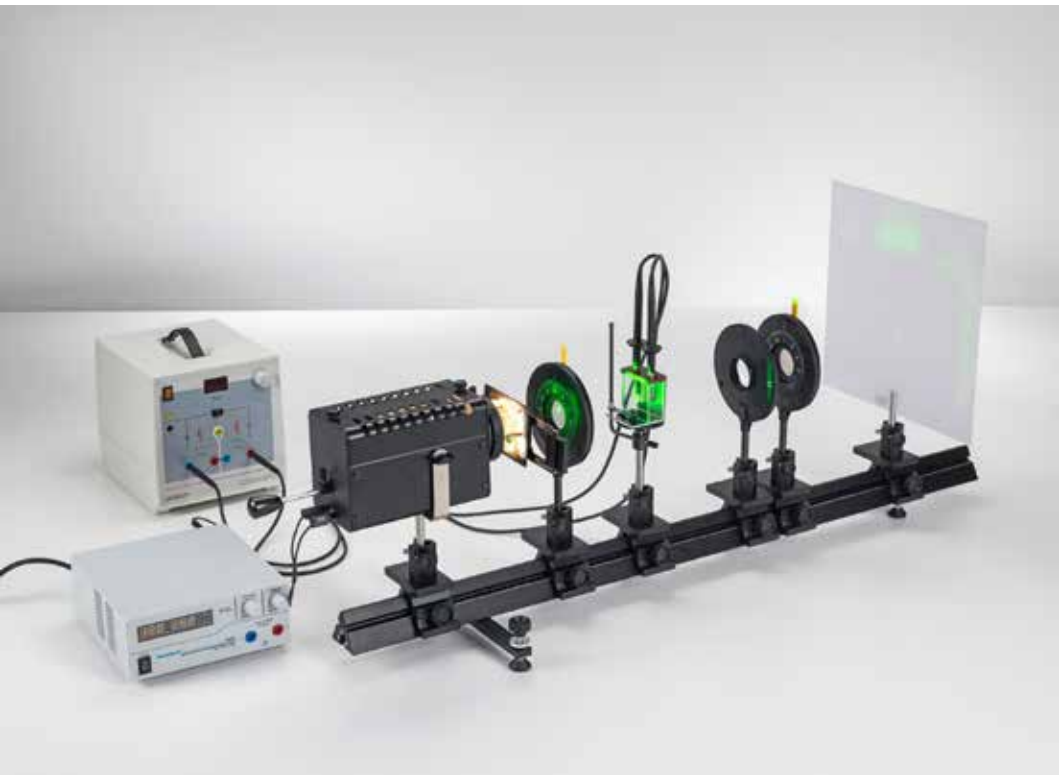
Estudio del efecto Kerr en nitrobenzol (P5.4.4.1)
