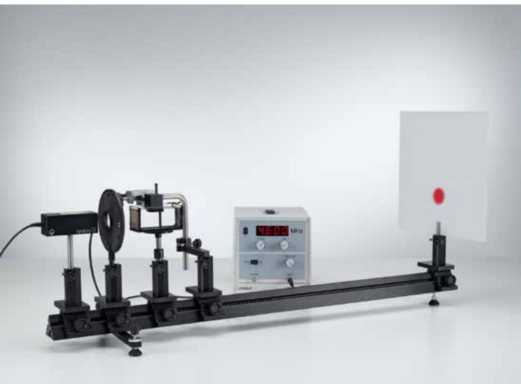
Determinación de la velocidad del sonido en líquidos - ondas ultrasónicas estacionarias como un retículo óptico (P1.7.8.1)
