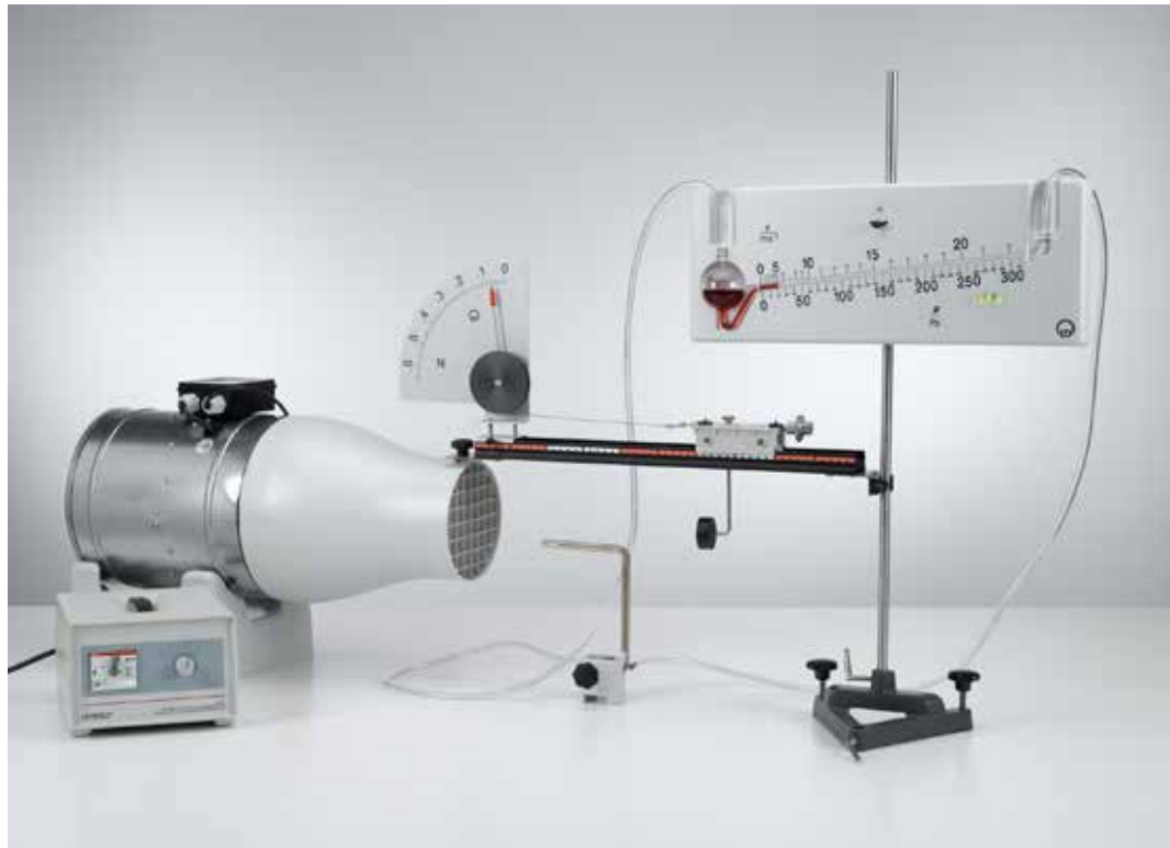
Resistencia del aire en función de la velocidad del viento y de la forma del cuerpo - Medición de presión con el manómetro fino (P1.8.6.1)
