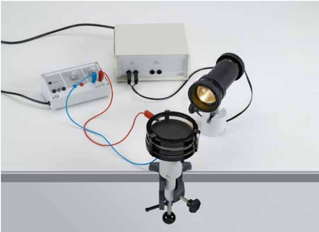
Demostración de las trayectorias de partículas \alpha en la cámara de niebla de Wilson (P6.5.1.1)
