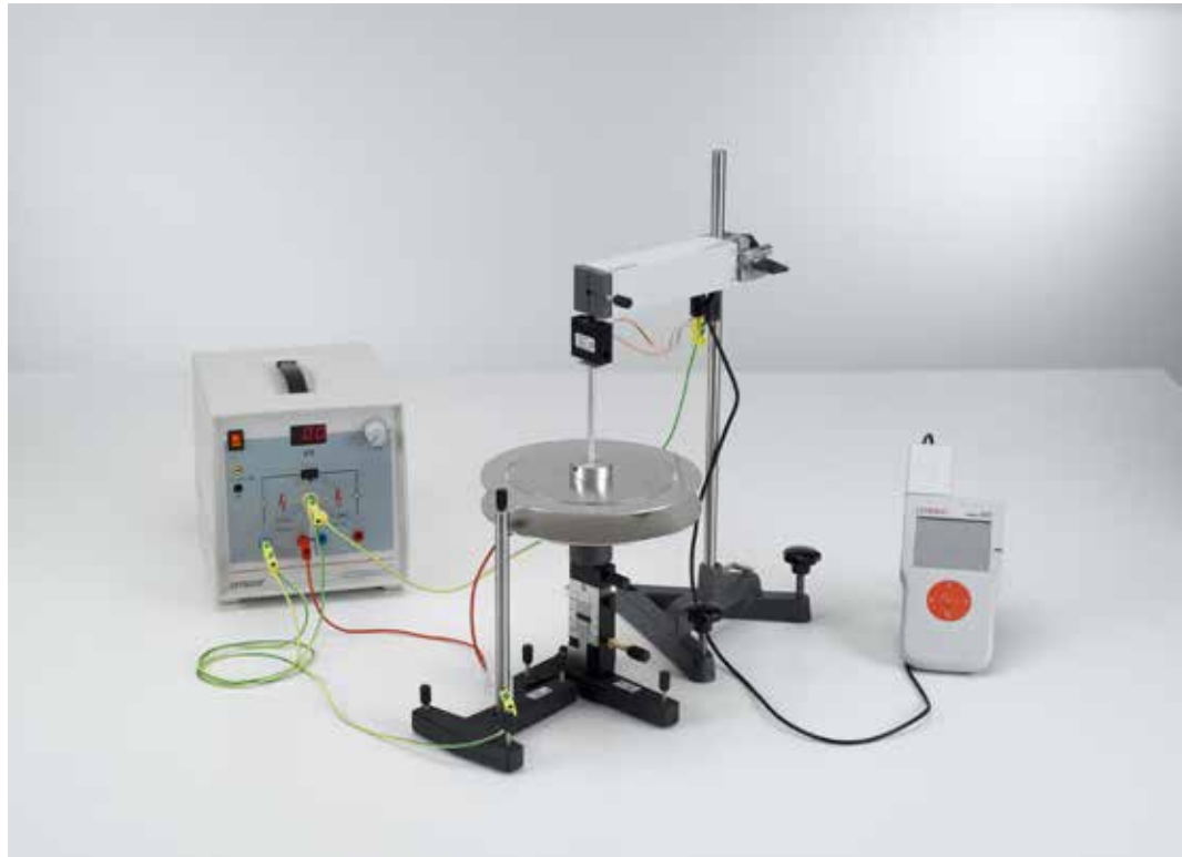
Balanza de tensión de Kirchhoff: Medición de la fuerza entre las placas cargadas de un condensador de placas - Medición con el sensor de fuerzas (P3.1.4.2)
