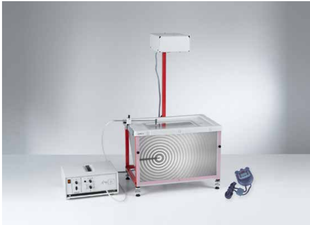
Excitación de ondas superficiales circulares y rectilíneas en agua (P1.6.4.1)
