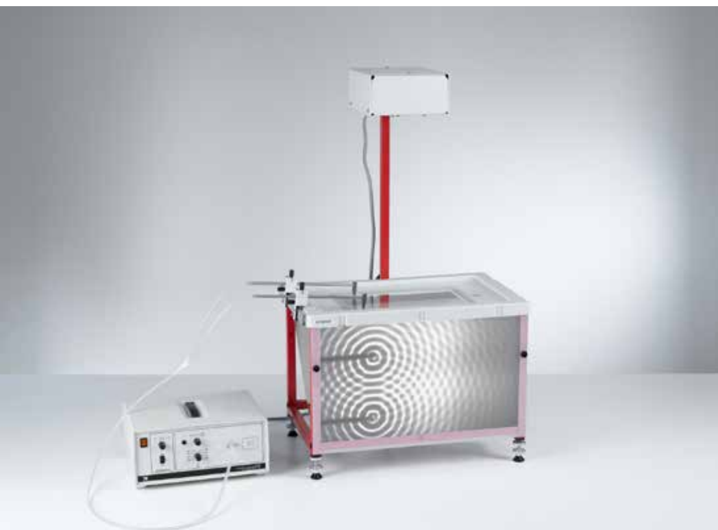
Interferencia entre dos ondas superficiales (P1.6.5.1)
