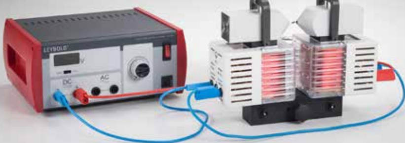
Materiales diamagnéticos, paramagnéticos y ferromagnéticos en un campo magnético no homogéneo (P7.3.1.1)
