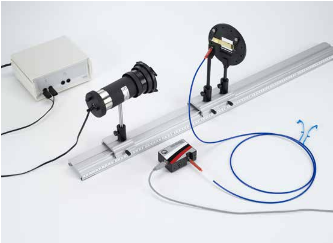
Espectros de reflexión de materiales diferentes - Registro y evaluación con un espectrofotómetro (P5.2.5.1)
