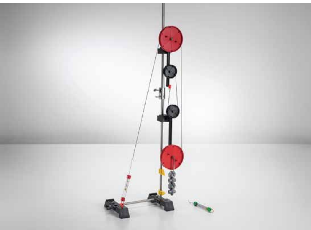
Polea fija, polea suelta y polipasto como máquinas simples (P1.2.4.1)
