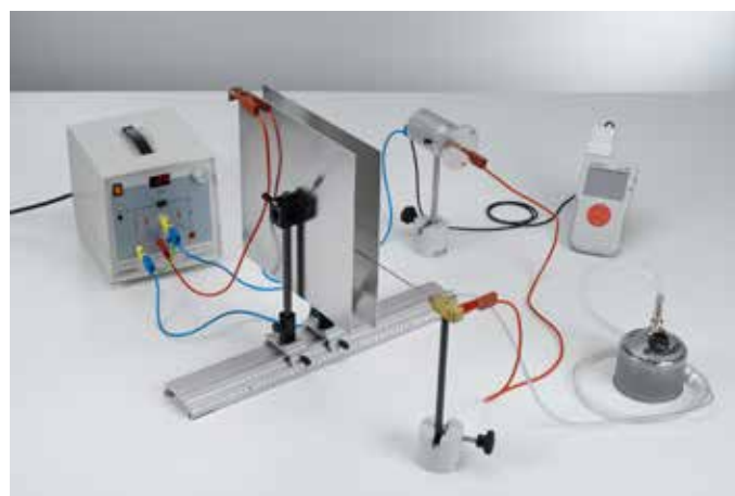
Medición del potencial dentro de un condensador de placa (P3.1.3.3)
