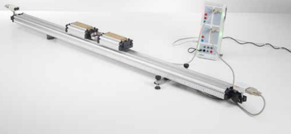
Tercer axioma de Newton y leyes de choques - Registro y evaluación con dos sensores de ultrasonido y CASSY (P1.3.4.5)
