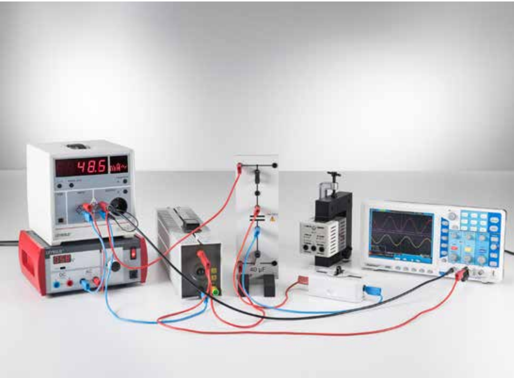
Determinación de la potencia activa y la potencia reactiva en circuitos de corriente alterna (P3.6.6.5)
