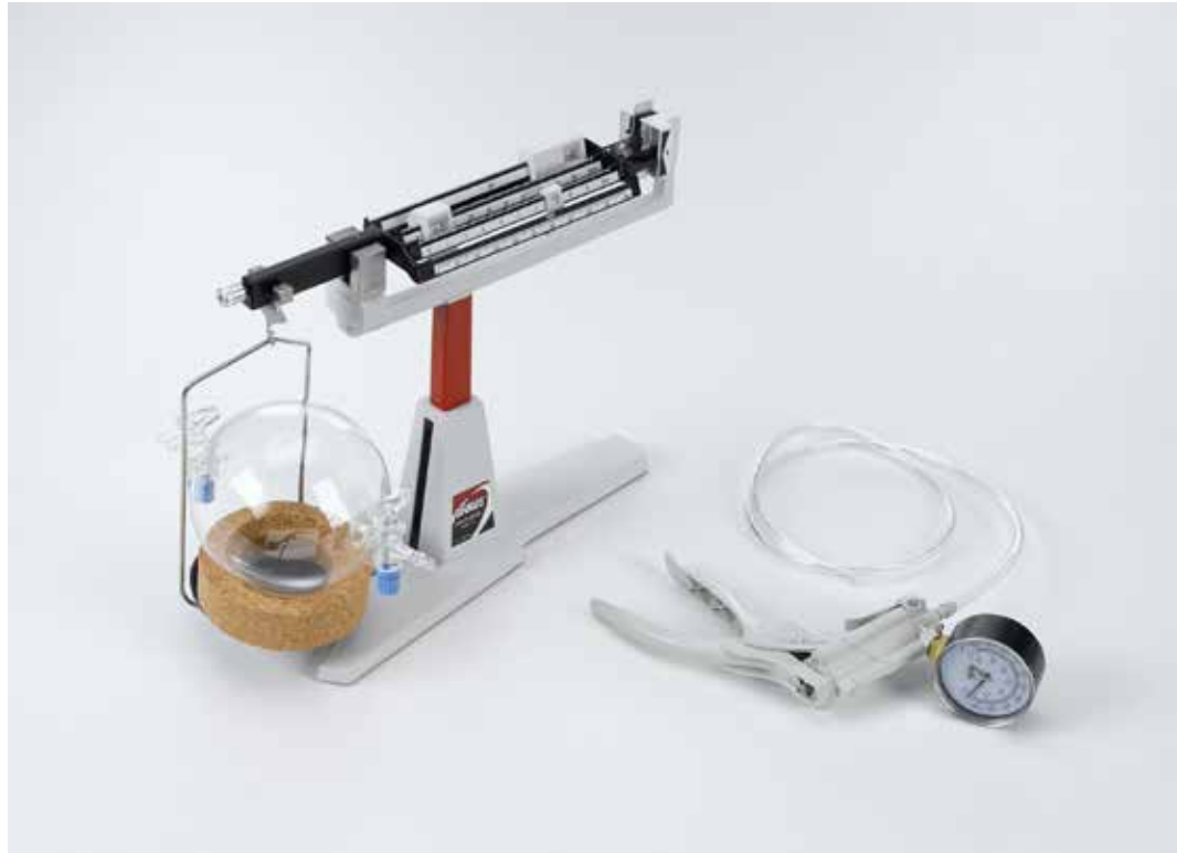
Determinación de la densidad del aire (P1.1.2.4)
