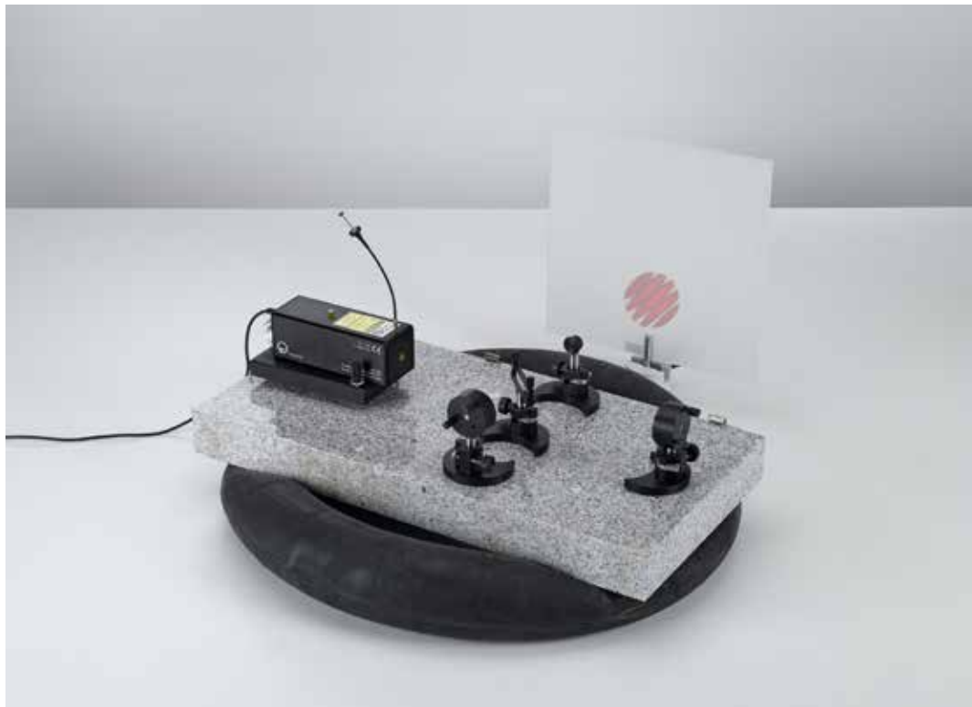
Montaje de un interferómetro de Michelson sobre la placa base para óptica con láser (P5.3.4.1)
