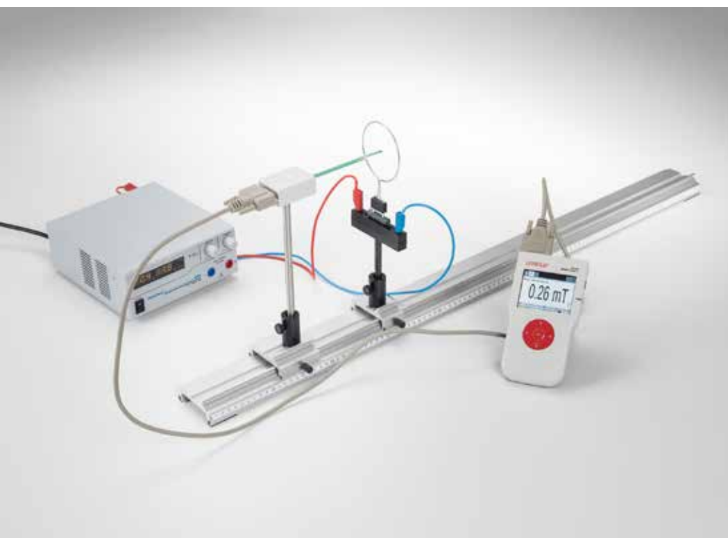
Medición del campo magnético en conductores rectilíneos y en lazos conductores circulares (P3.3.4.1)
