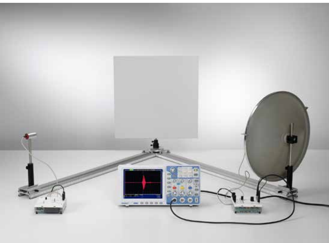
Reflexión de ondas ultrasónicas planas en una superficie plana (P1.7.4.1)
