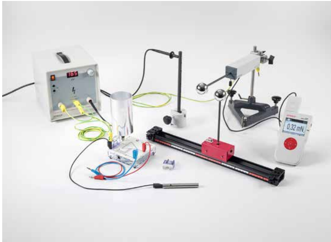
Verificación de la ley de Coulomb - Medición con el sensor de fuerzas (P3.1.2.2)
