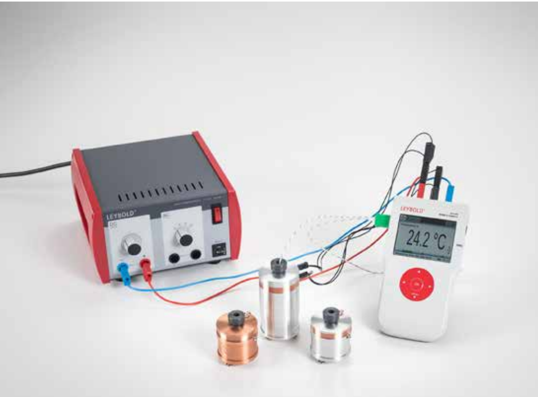
Conversión de energía eléctrica en energía calorífica - Medición con Mobile-CASSY (P2.3.4.4)
