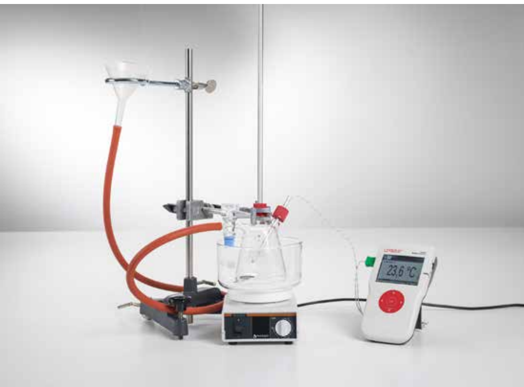
Estudio de la densidad máxima del agua - Medición con Mobile-CASSY (P2.1.3.2)
