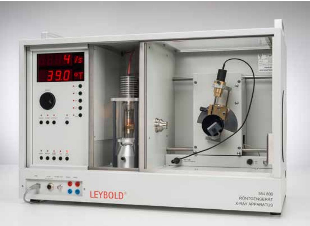
Estructura fina de los rayos X característicos de un ánodo de molibdeno (P6.3.6.1)
