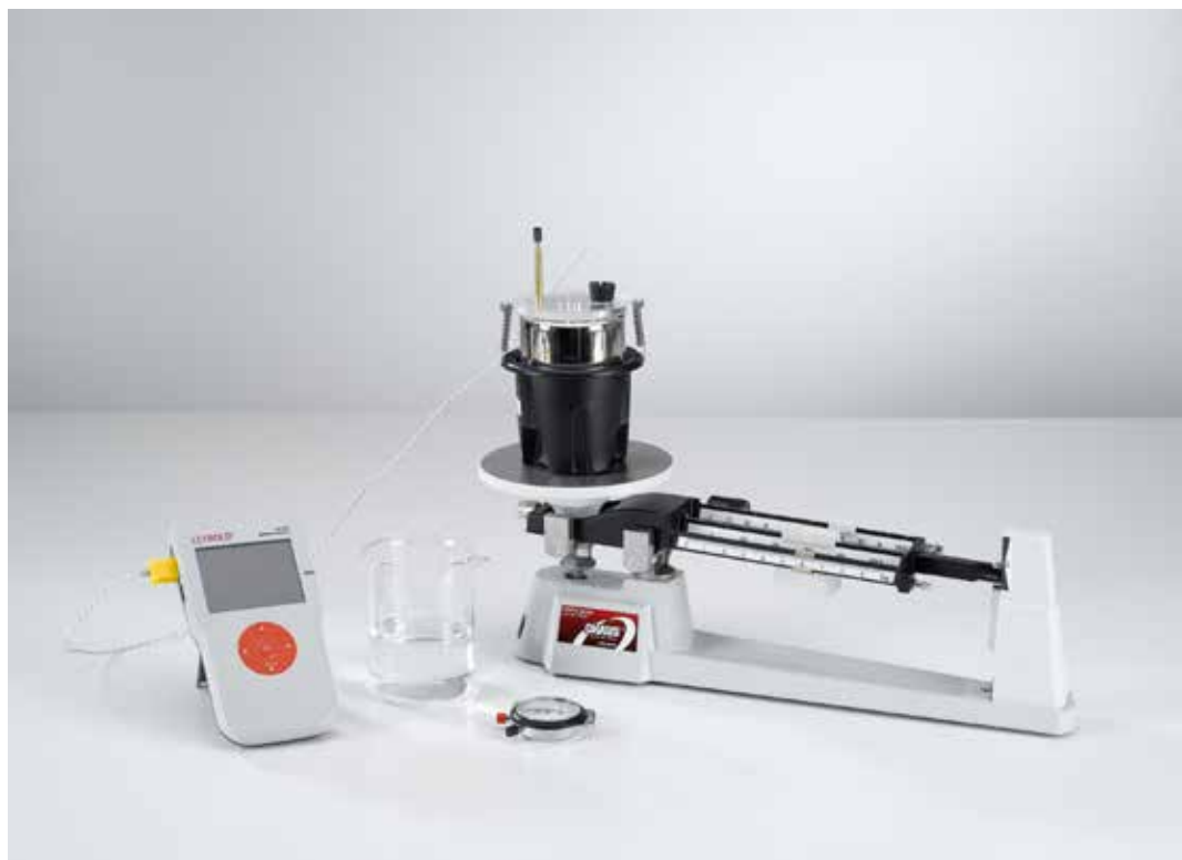
Medición de temperatura de una mezcla de agua - Medición con Mobile-CASSY (P2.3.1.2)
