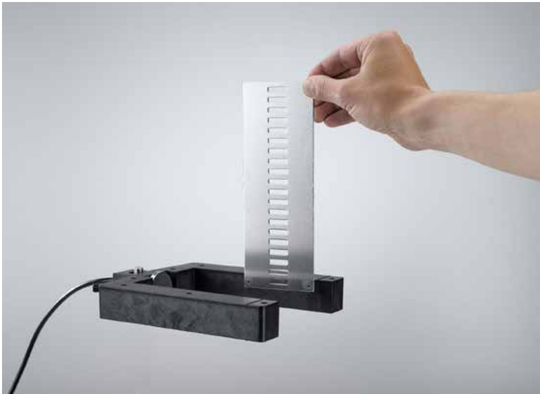
Caída libre: Medición múltiple del tiempo con la escalerilla g (P1.3.5.3)
