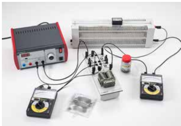
Transformación de la tensión con un transformador en carga (P3.4.5.2)
