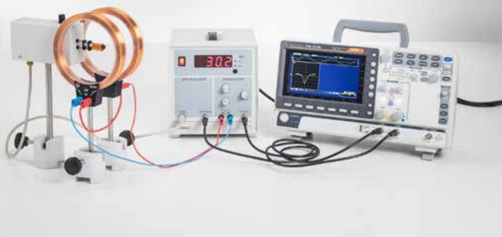
Resonancia de espín electrónico en DPPH – Determinación del campo magnético en función de la frecuencia de resonancia (P6.2.6.2)
