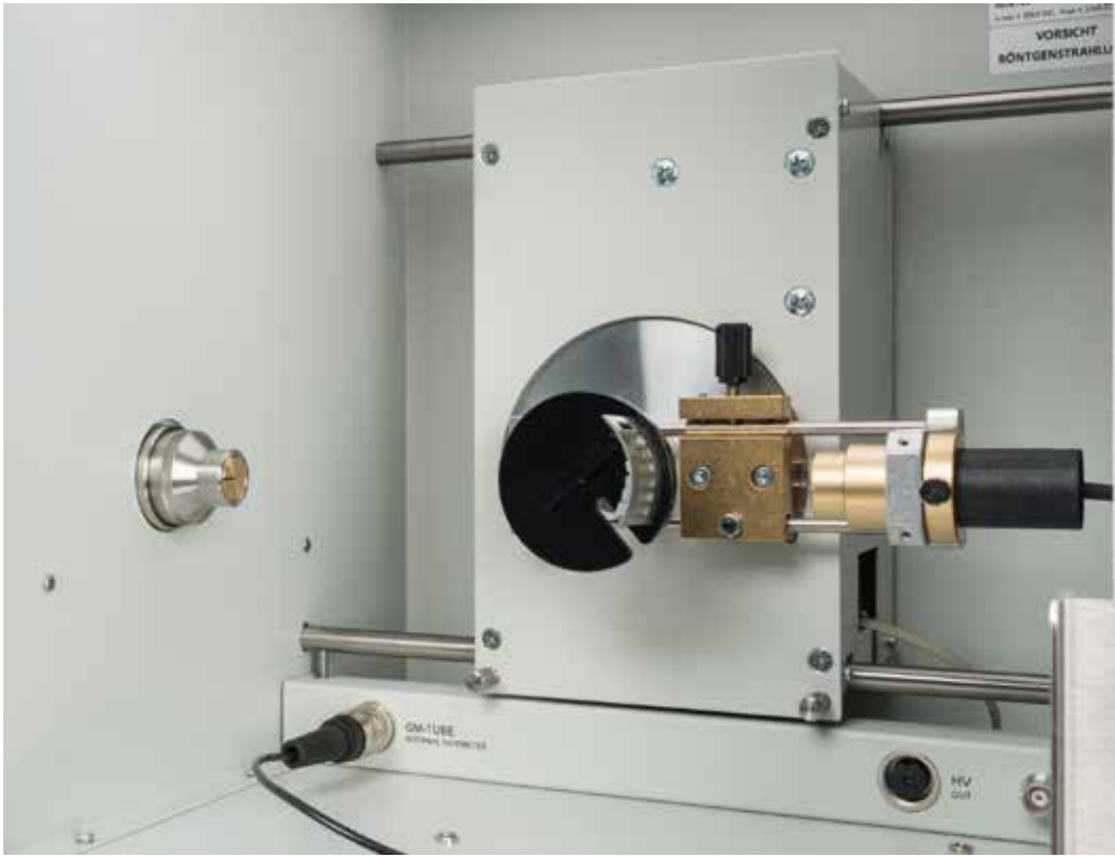
Estudio de la atenuación de rayos X en función del material y el espesor del absorbente (P6.3.2.1)
