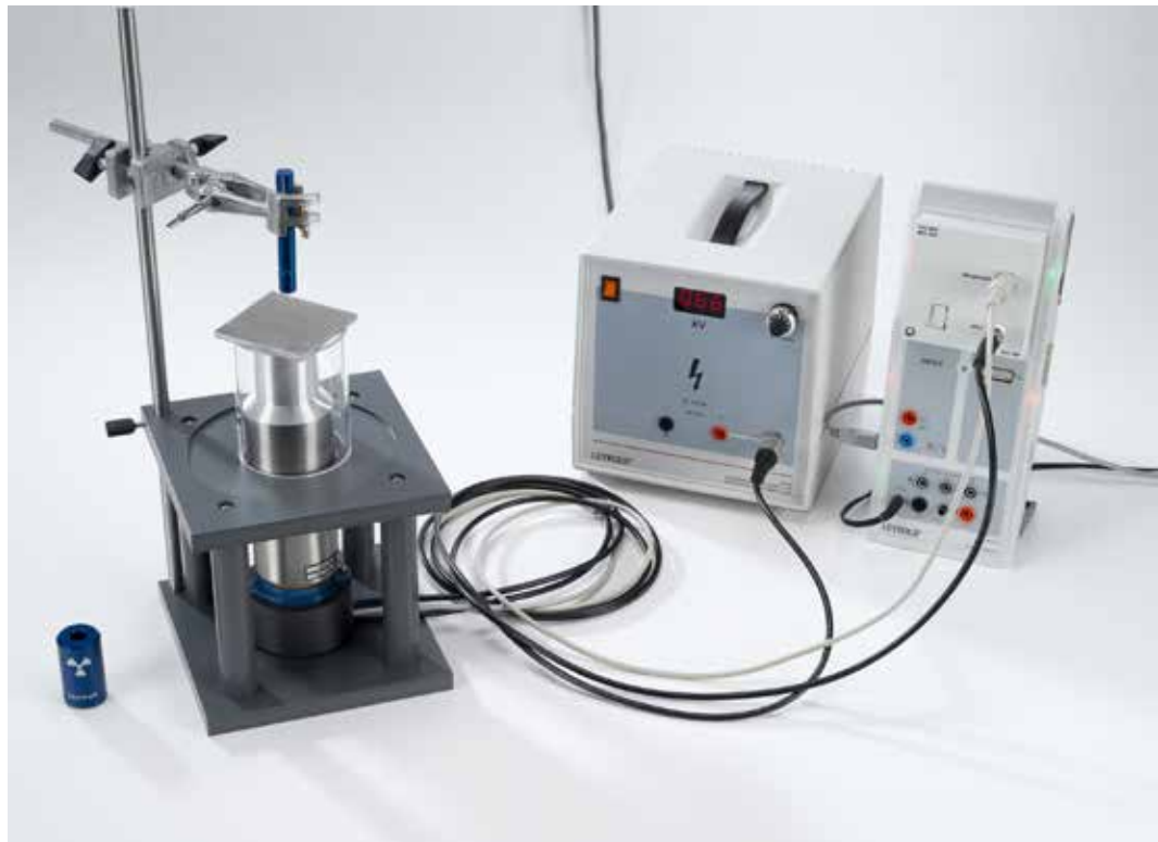
Absorción de radiación \gamma (P6.5.5.3)
