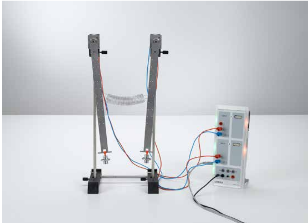
Péndulo acoplado - Registro y evaluación con CASSY (P1.5.4.4)
