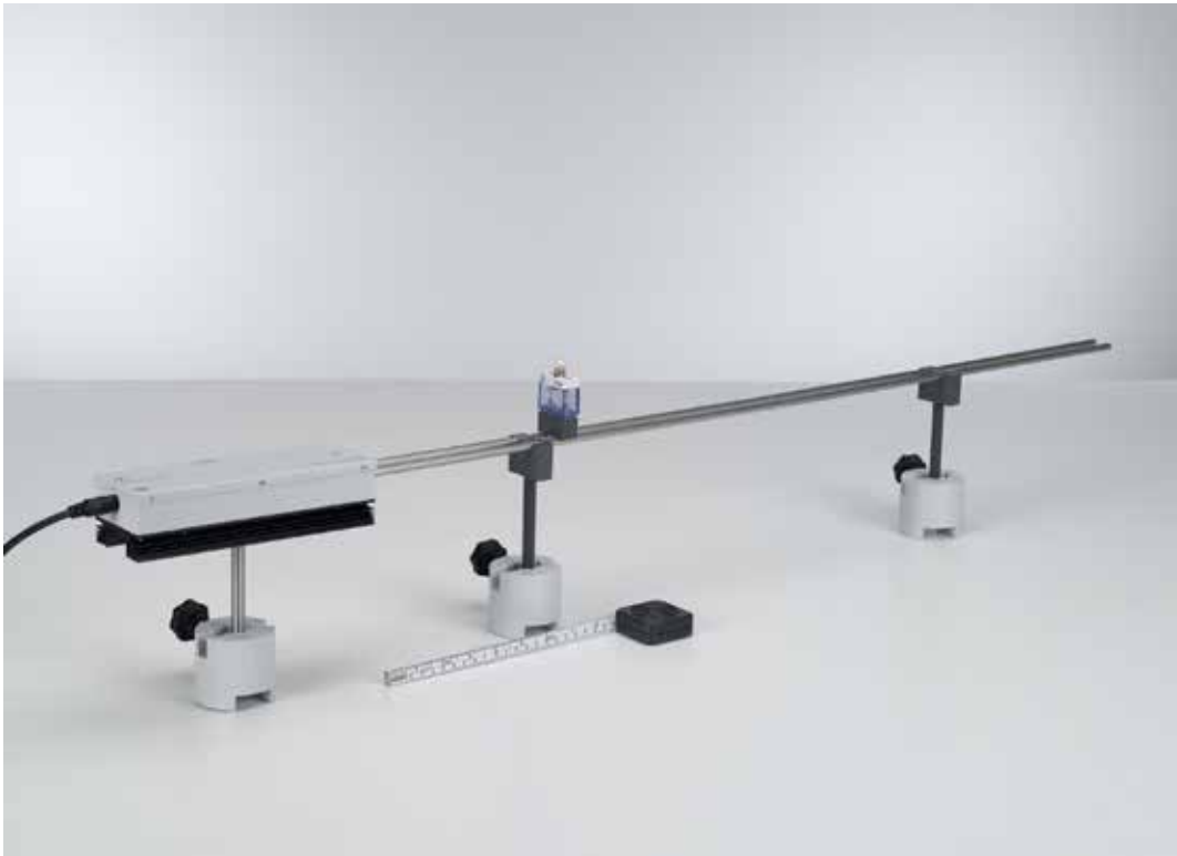
Determinación de los máximos de corriente y de tensión en una línea de Lecher (P3.7.3.1)
