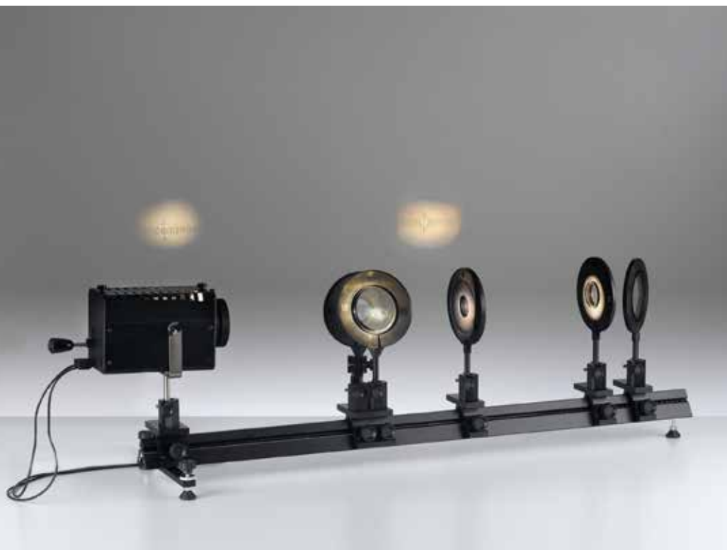
Anillos de Newton con luz blanca transmitida y reflejada (P5.3.3.2)
