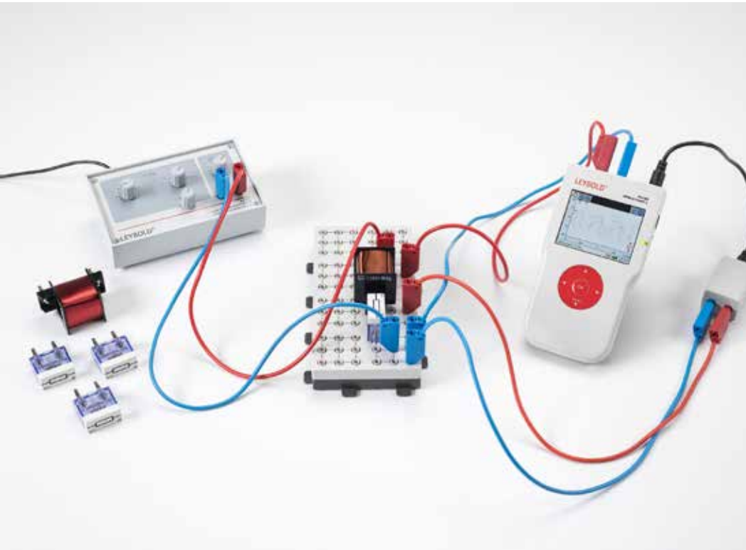
Medición de la corriente en una bobina al conectar y desconectar la corriente continua - Medición con Mobile-CASSY (P3.6.2.3)
