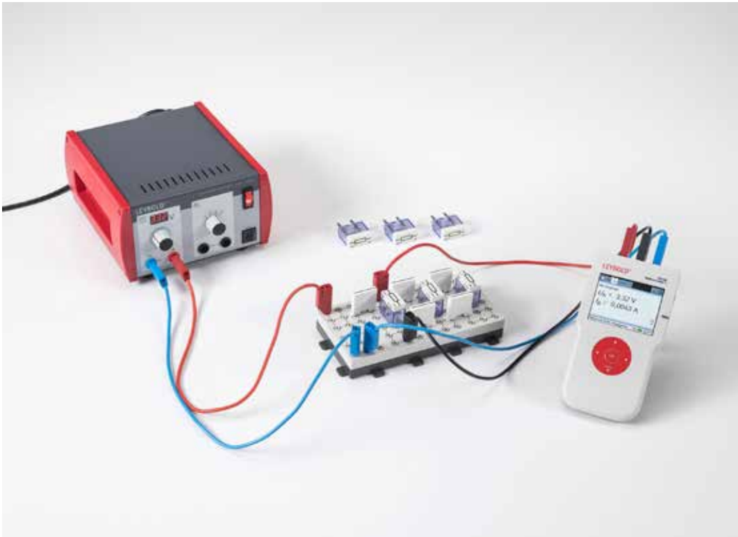
Medición de corriente y tensión en resistencias conectadas en paralelo y en serie (P3.2.3.1)
