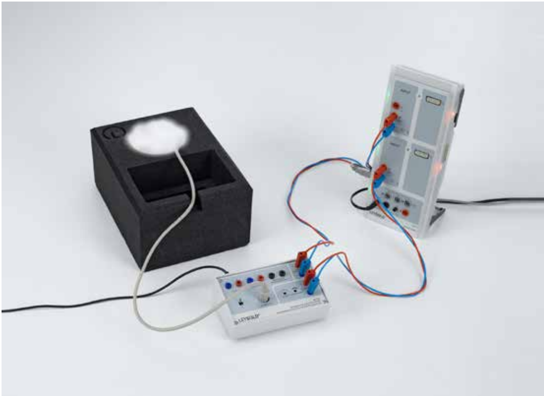
Determinación de la temperatura crítica de un superconductor de alta temperatura (P7.2.6.1)
