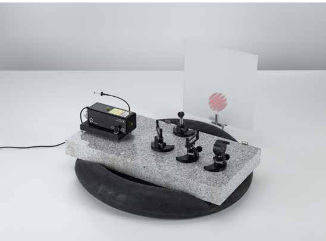
Determinación de la longitud de onda de un láser de He-Ne con un interferómetro de Fabry-Perot (P5.3.5.3)
