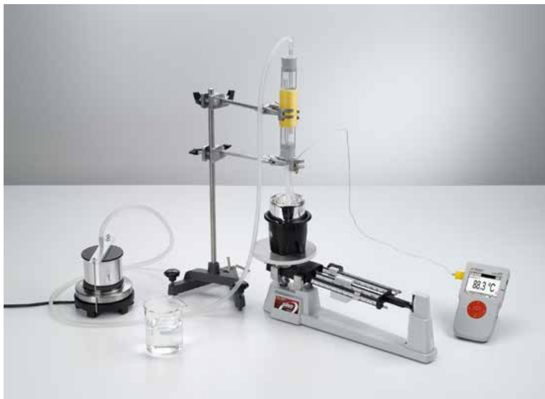
Determinación del calor específico de evaporación del agua - Medición con Mobile-CASSY (P2.4.1.3)
