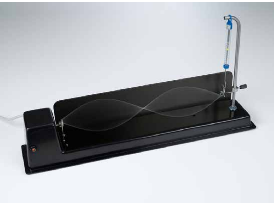
Estudio de las ondas circularmente polarizadas de una cuerda en el montaje experimental de Melde (P1.6.3.1)
