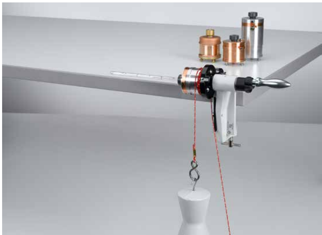
Conversión de energía mecánica en energía calorífica - Registro manual y evaluación de los valores medidos (P2.3.3.1)
