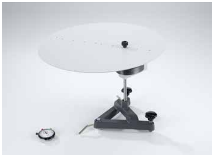
Confirmación del teorema de Steiner (P1.4.5.3)
