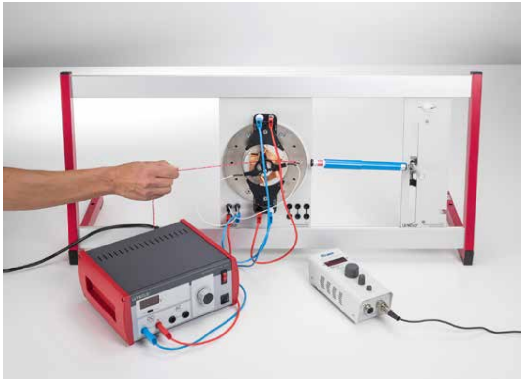
Estudio de un motor universal en conexión en derivación (P3.5.3.3)
