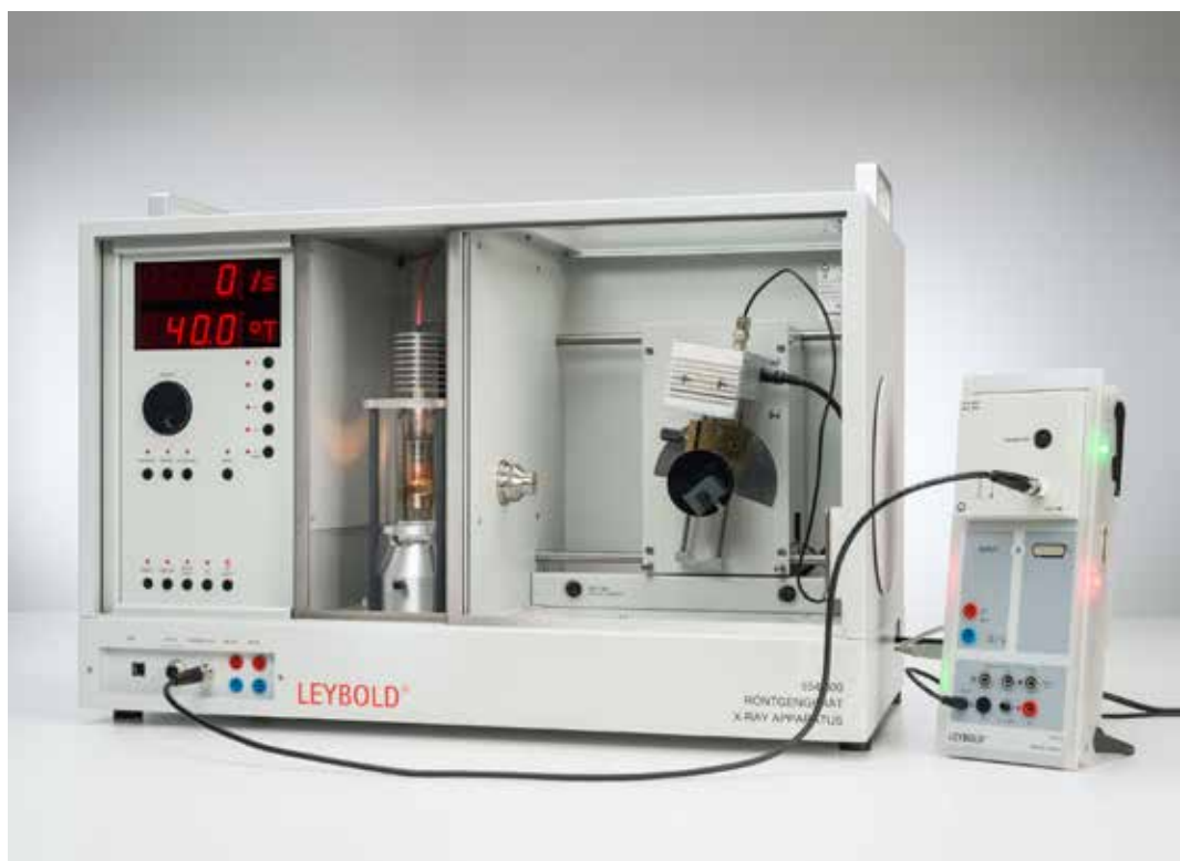
Registro y calibración de un espectro energético de rayos X (P6.3.5.1)
