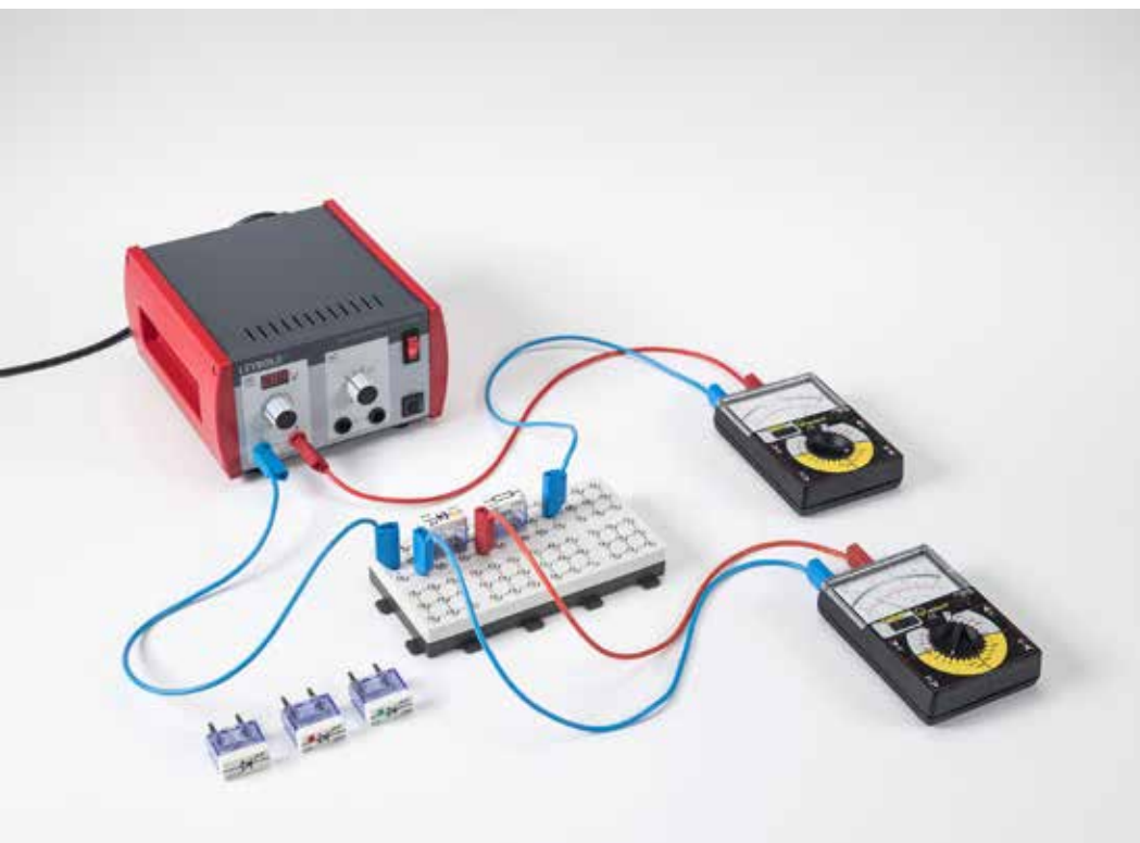
Registro de las curvas características de corriente y tensión de diodos luminosos (LED) (P4.1.3.3)
