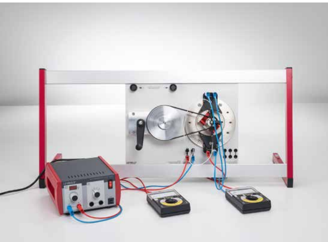
Generación de tensión alterna con un generador de central eléctrica (generador con polo interior electromagnético) (P3.5.2.3)
