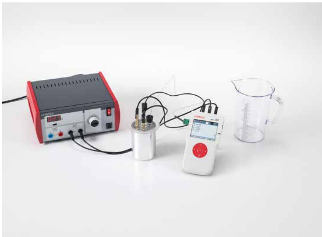
Determinación de la potencia térmica de una carga óhmica en un circuito de corriente alterna en función de la tensión aplicada (P3.6.6.1)
