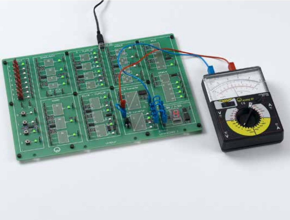
Conversor de señal analógica a digital (P4.5.3.1)
