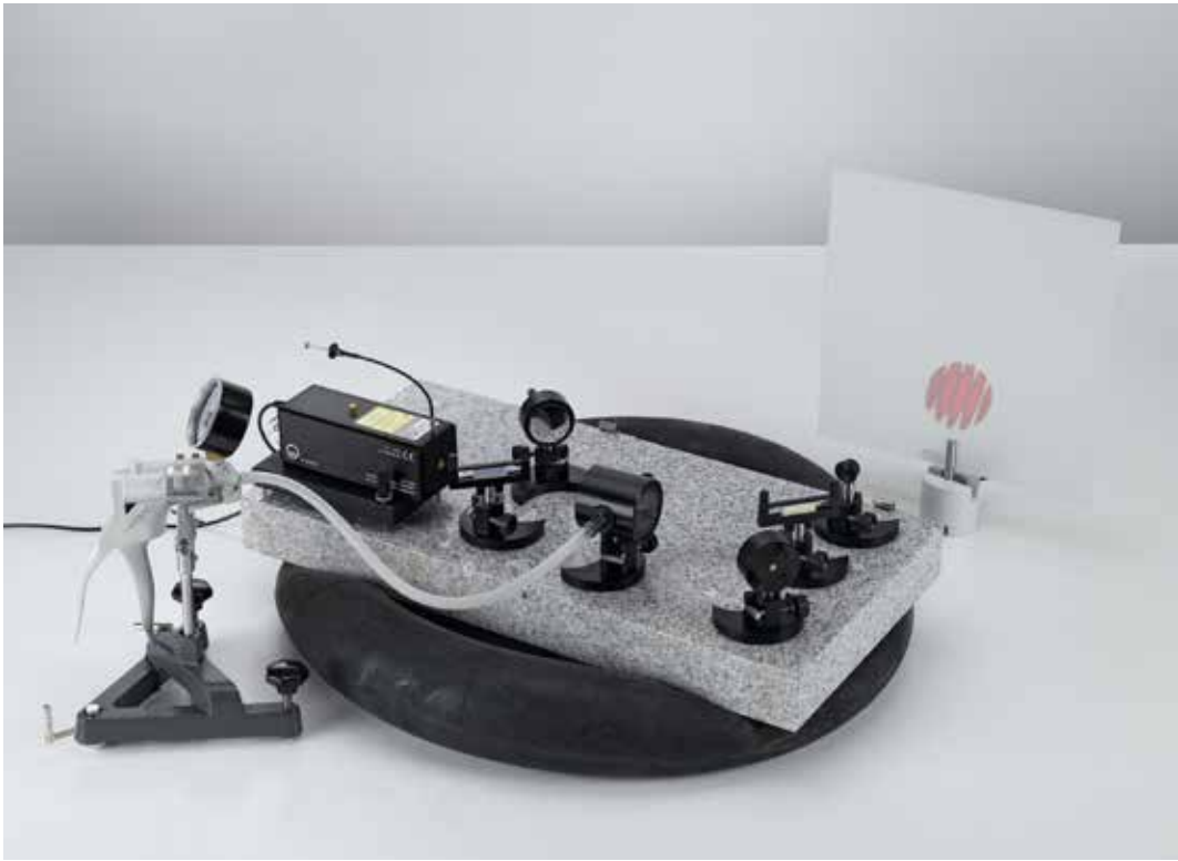
Medición del índice de refracción del aire con un interferómetro de Mach-Zehnder (P5.3.5.2)
