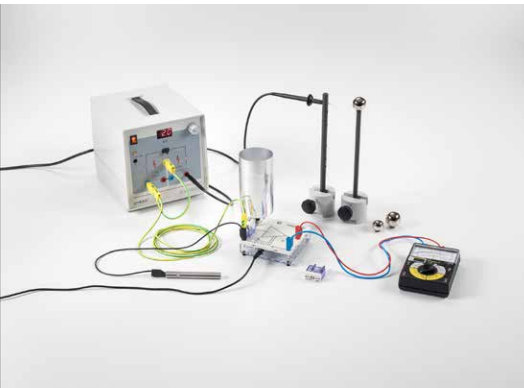
Determinación de la capacitancia de una esfera en el espacio libre (P3.1.6.1)
