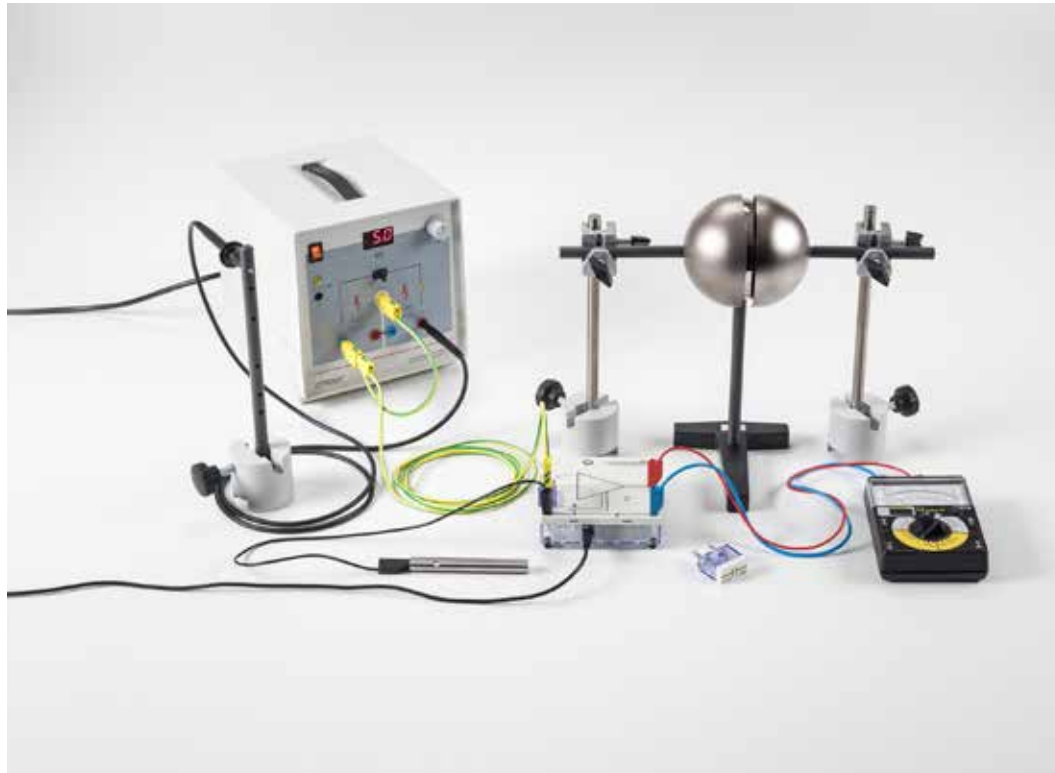
Experimentos sobre influencia con las semiesferas de Cavendish (P3.1.5.2)
