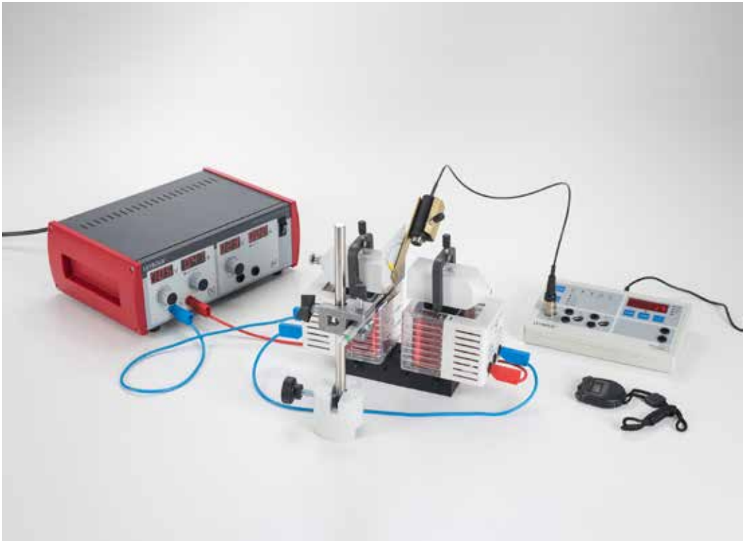
Desviación de radiación beta en el campo magnético (P6.5.7.1)
