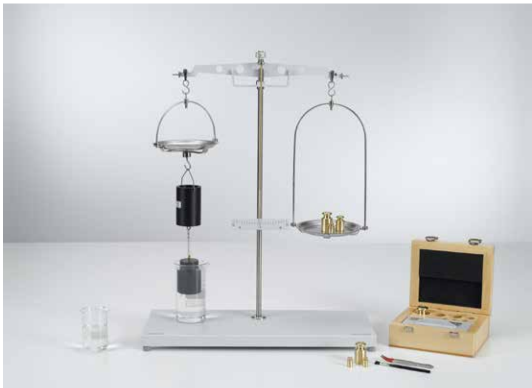
Comprobación del principio de Arquímedes (P1.8.2.1)
