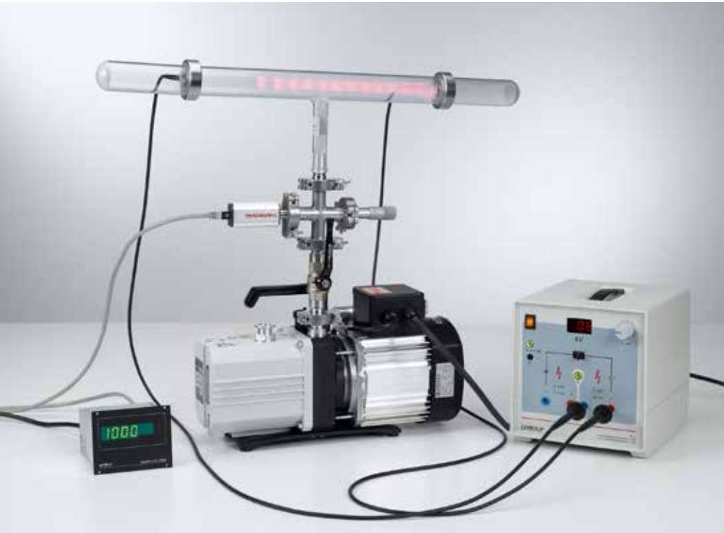
Descarga de gas automantenida en el aire en función de la presión (P3.9.2.1)
