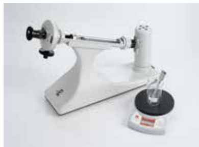
Determinación de la concentración en soluciones de azúcar con un polarímetro común (P5.4.3.4)
