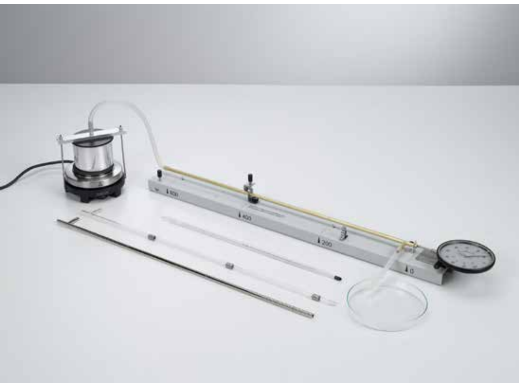
Dilatación térmica de sólidos - Medición con el aparato de dilatación (P2.1.1.2)
