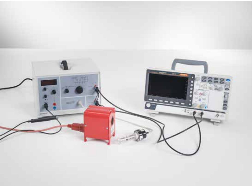
Experimento de Franck-Hertz en mercurio – Registro con osciloscopio (P6.2.4.1)
