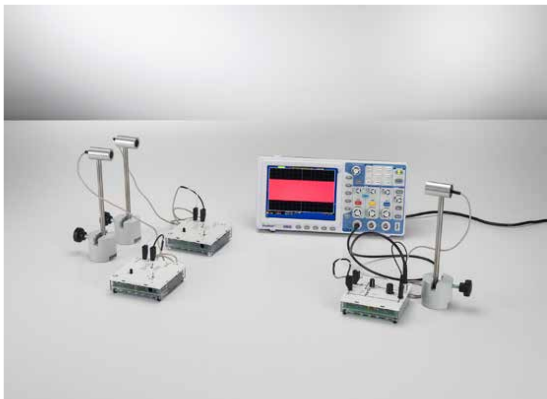
Pulsaciones de ondas ultrasónicas (P1.7.5.1)
