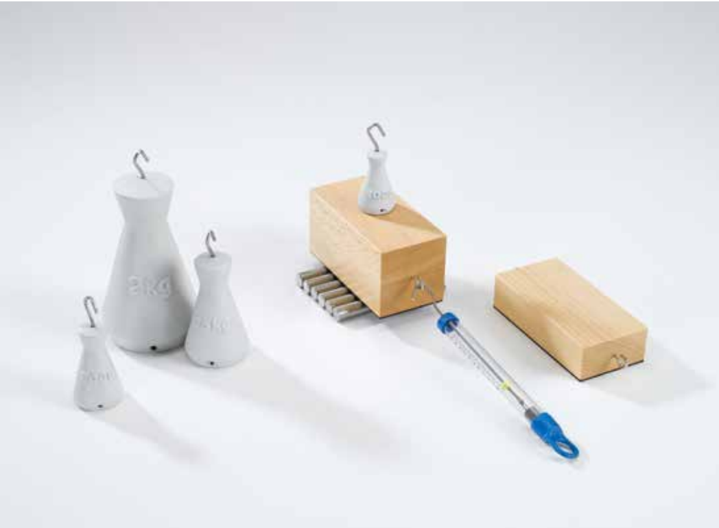
Fricción estática, de deslizamiento y de rodadura (P1.2.6.1)
