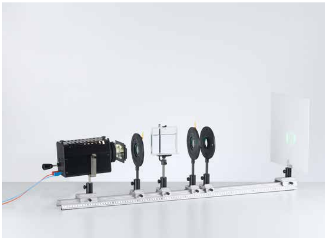
Rotación del plano de polarización mediante soluciones de azúcar (P5.4.3.2)
