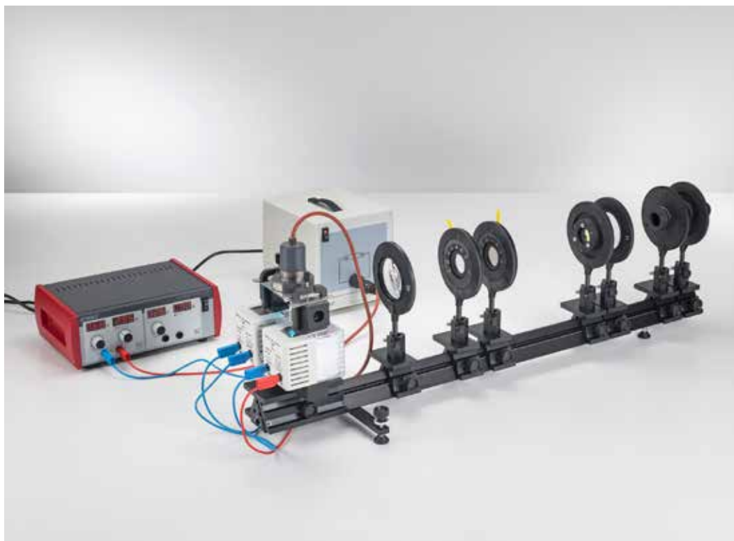
Observación del efecto Zeeman normal en una configuración transversal y en una configuración longitudinal - espectroscopía con un etalómetro de Fabry-Perot (P6.2.7.3)
