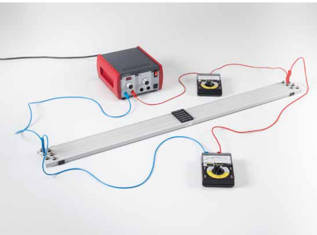
Comprobación de la ley de Ohm y medición de resistencias específicas (P3.2.2.1)
