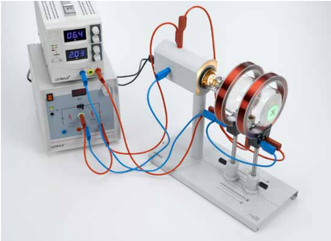
Desviación de los electrones en un campo magnético axial (P3.8.3.2)
