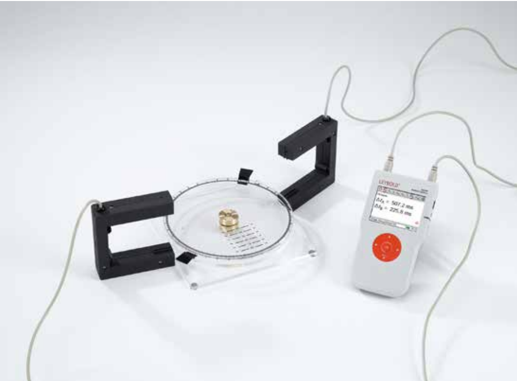
Conservación del momento angular en un choque giratorio elástico e inelástico (P1.4.2.1)
