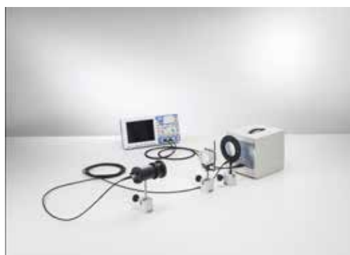
Medición de la velocidad de la luz en el vidrio acrílico (P5.6.3.2)
