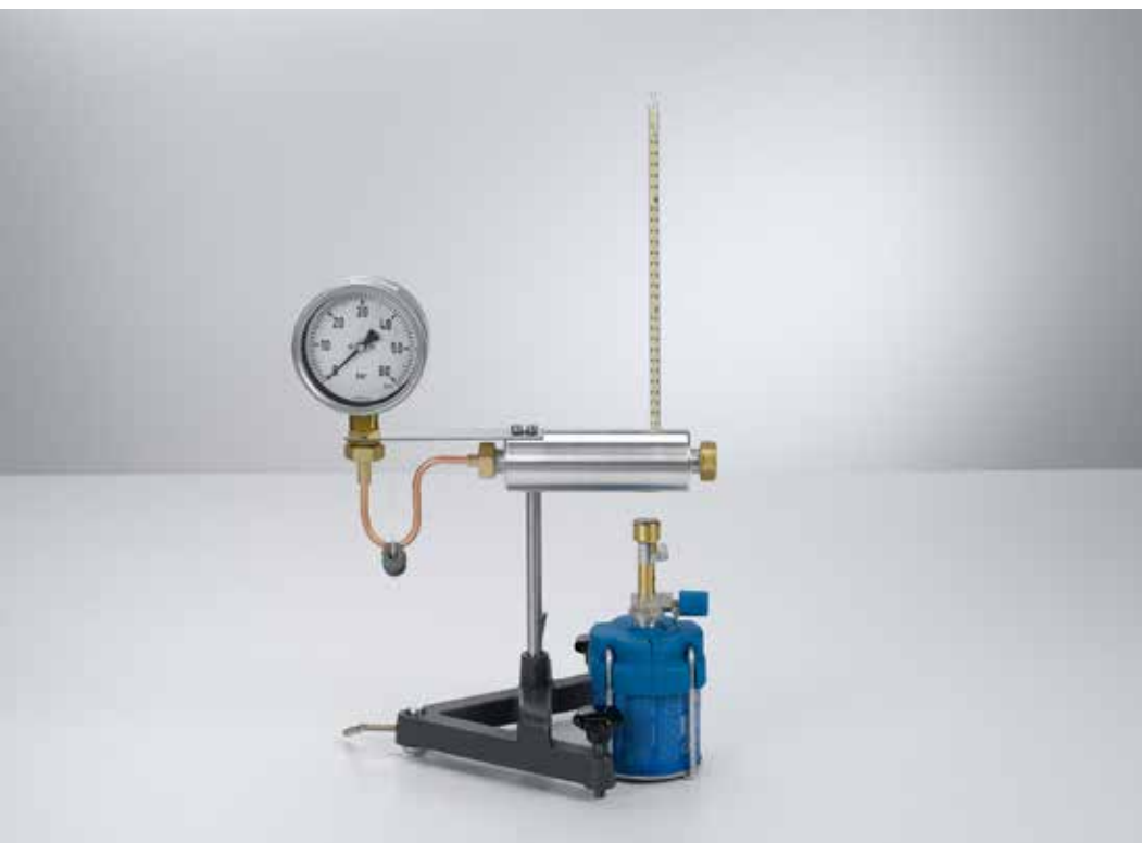
Registro de la curva de presión de vapor de agua con presiones de hasta 50 bar (P2.4.2.2)
