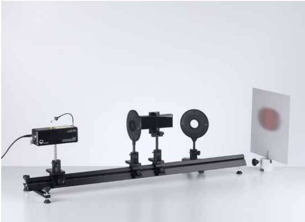
Interferencia en un espejo de Fresnel con un láser de He-Ne (P5.3.2.1)
