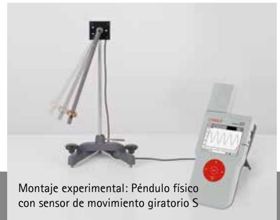
Montaje experimental: Péndulo físico con sensor de movimiento giratorio S
