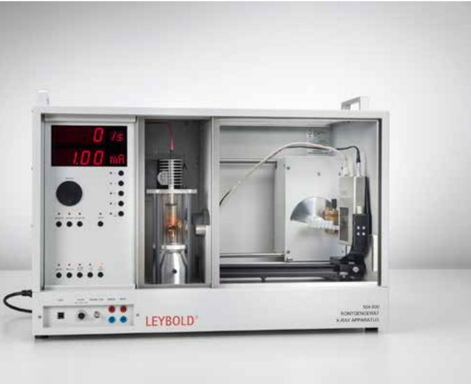
Medición y representación de una tomografía computarizada con el sensor de imágenes de rayos X (P6.3.8.11)
